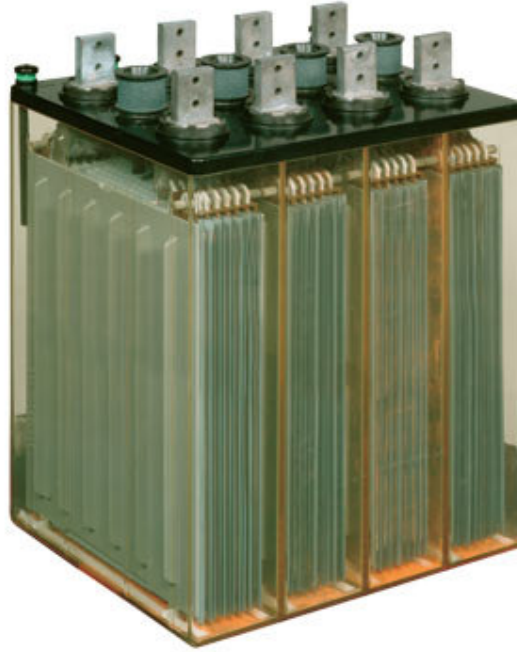
Şekil 2.1 Dört hücreli denizaltı bataryası
