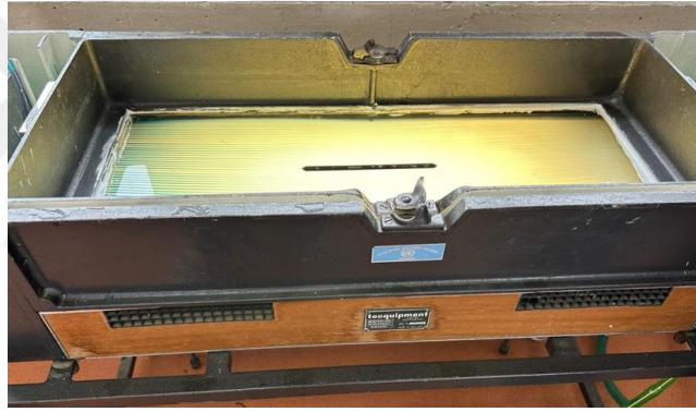
Şekil 25. Akış gözleme deney düzeneğinin üstten görünüşü
