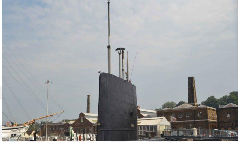
Şekil 2.10: HMS Ocelot'un yüzgeci, periskop ve tüplerin bir fotoğrafı.
