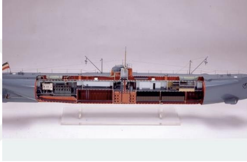
Şekil 2.57: Seehund Denizaltısı'nın bölümlerini gösteren bir kesit modeli.
