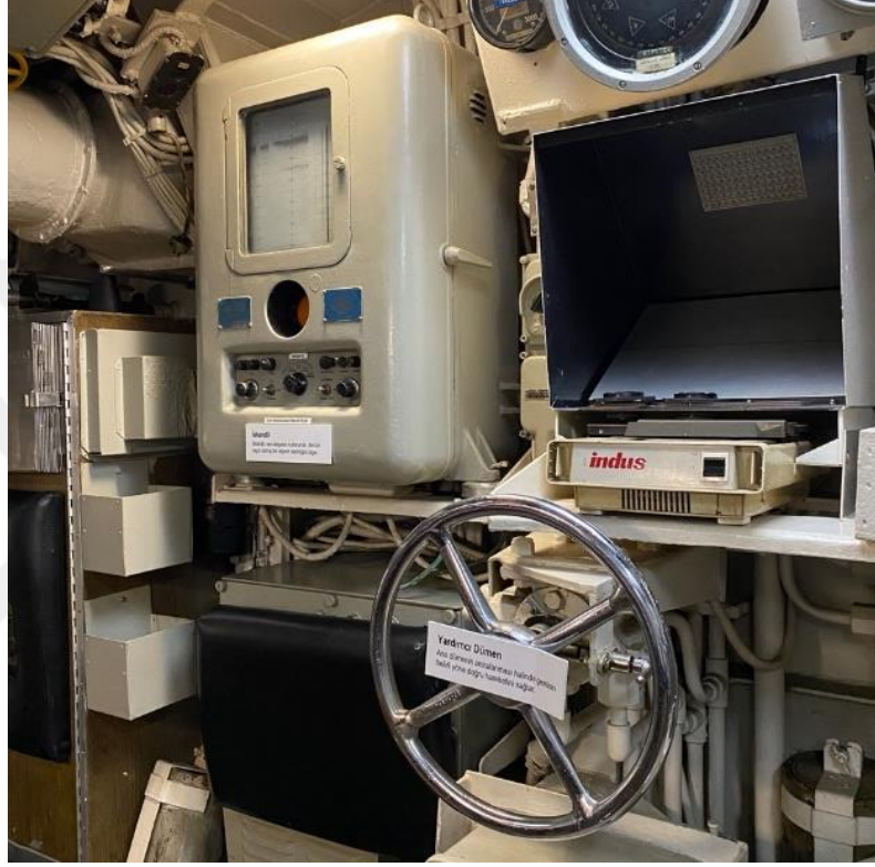
Şekil 3.26: Yardımcı dümeni ve iskandili gösteren bir fotoğraf.
