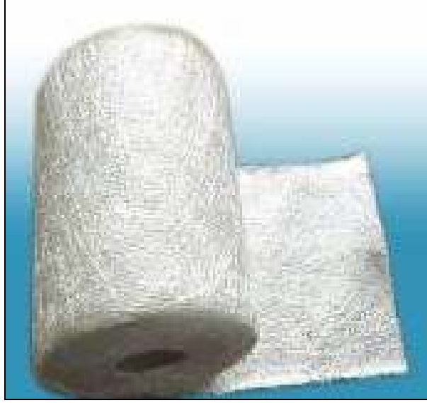
Şekil 2.2 Doğranmış cam liflerden yapılmış keçe elyaf. ( http://drywallmesh.en.alibaba.com/product/50025829/50061616/Fiberglass_Woven_Roving/Chopped_Strand_Mat.html )
