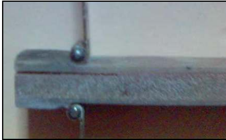
Şekil 2.11 Mode I deneyi için hazırlanmış sandviç kompozit numune.
