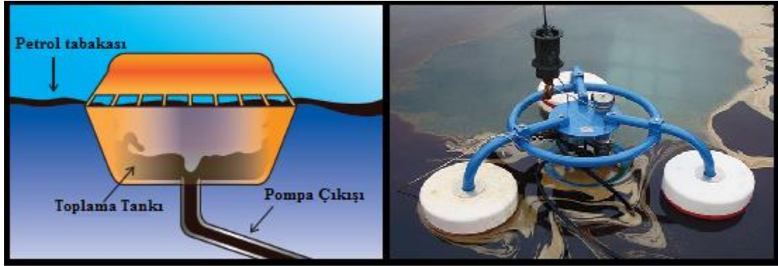
Şekil 9. Bent tipi skimerlerin şematik ve gerçek görüntüsü (Fingas, 2013; URL-6, 2013)
