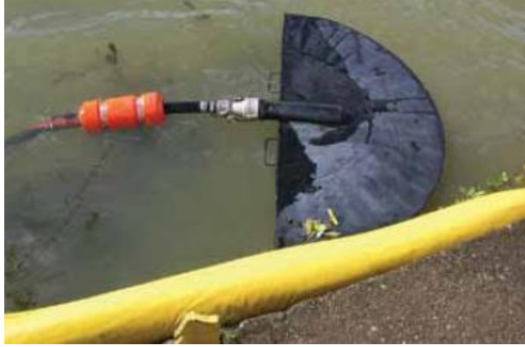
Şekil 10. Vakum pompasına bağlı emici uçlu bir sıyrıcı (ITOPF, 2012)
