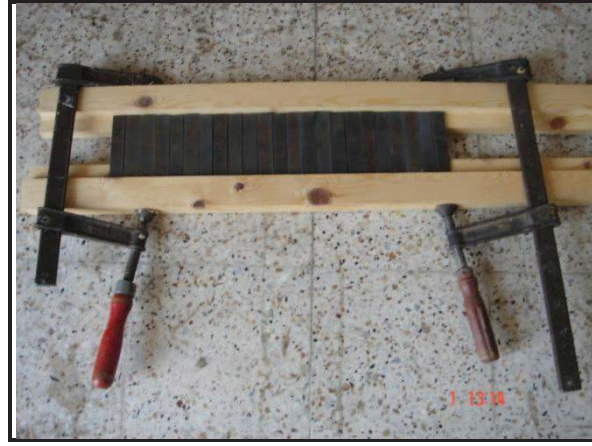
Şekil 3.3 Raspalanmış ve kaplanmaya hazır çelik numuneler
