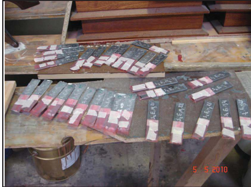
Şekil 3.5 Numunelerin teflonla kaplanması ve kodlanması
