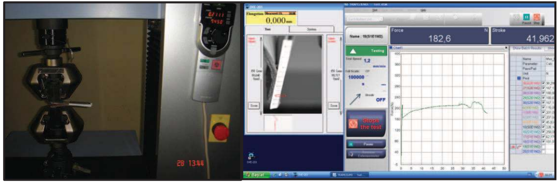
Şekil 3.9 Mode I deney düzeneği ve verilerin kaydedilmesi
