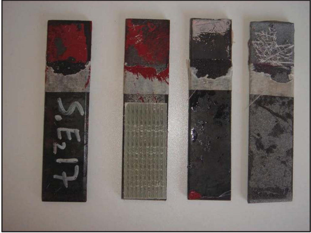
Şekil 4.5. Tek karşılıklı yapıştırırmalı bağlantının çelik kısmında hasarlanma
