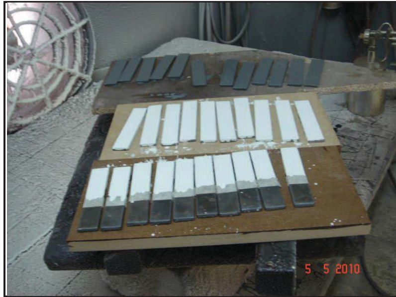
Şekil 3.4 Epoksi ile astarlanmış numuneler
