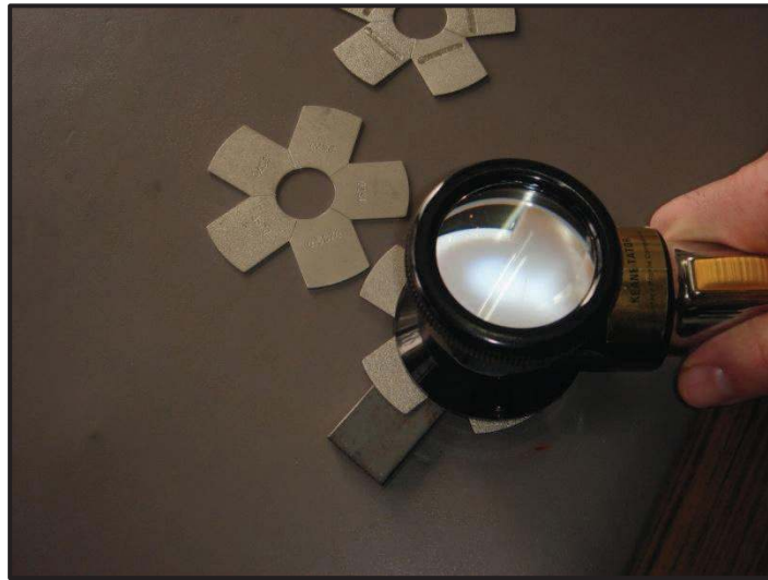
Şekil 3.2 Numunelerin yüzey pürüzlülüklerinin ölçümü
