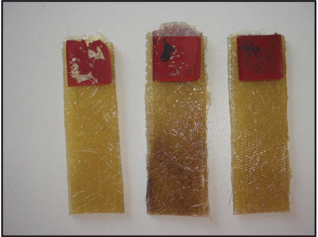
Şekil 4.5. Tek karşılıklı yapıştırırmalı bağlantının ETP kısmında hasarlanma
