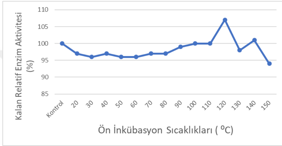
Şekil 4.5. SG-11 Proteaz Enzimi Termal Stabilite Değerleri
