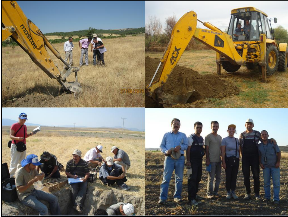
Şekil 3.9. Arazi çalışması sırasında iş makinesi vasıtasıyla profil çukuru kazılışı ve tanımlanması
