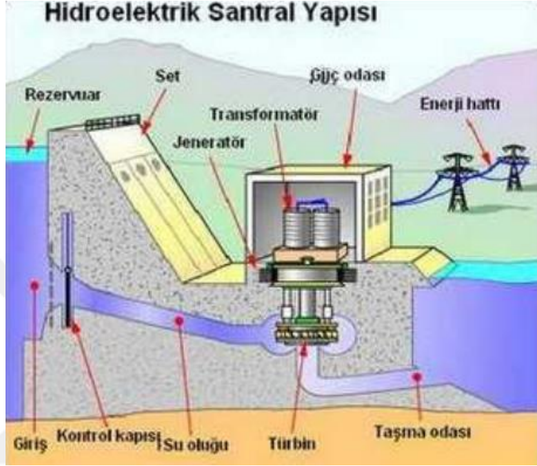
Şekil 2.1. Hidroelektrik Santral Kesiti
