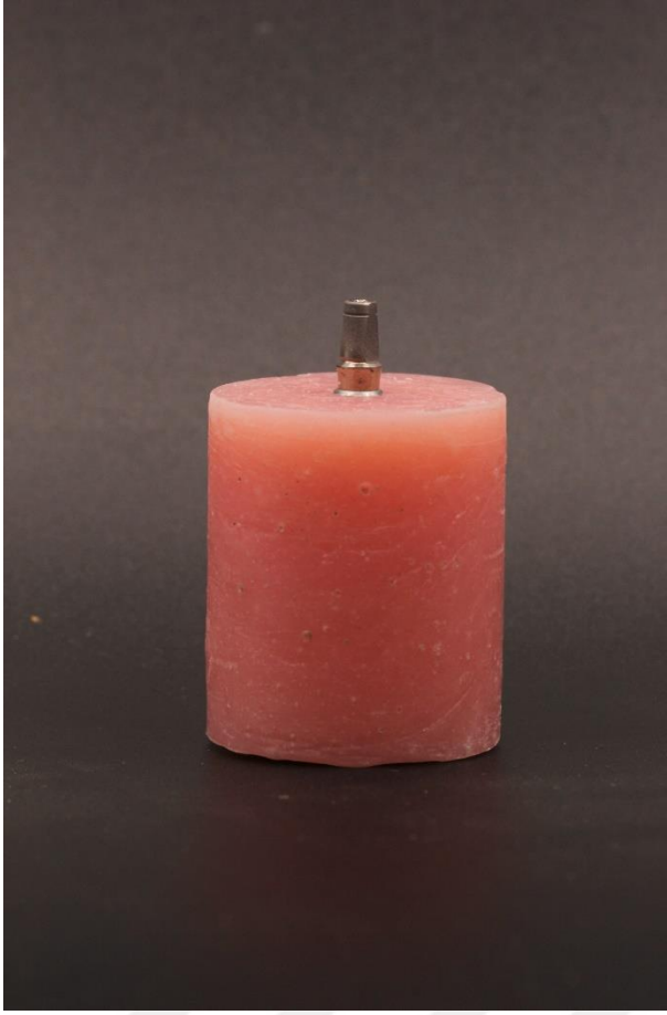
Şekil 3-4: Akrilik rezin bloğa gömülmüş implant analog ve abutment
