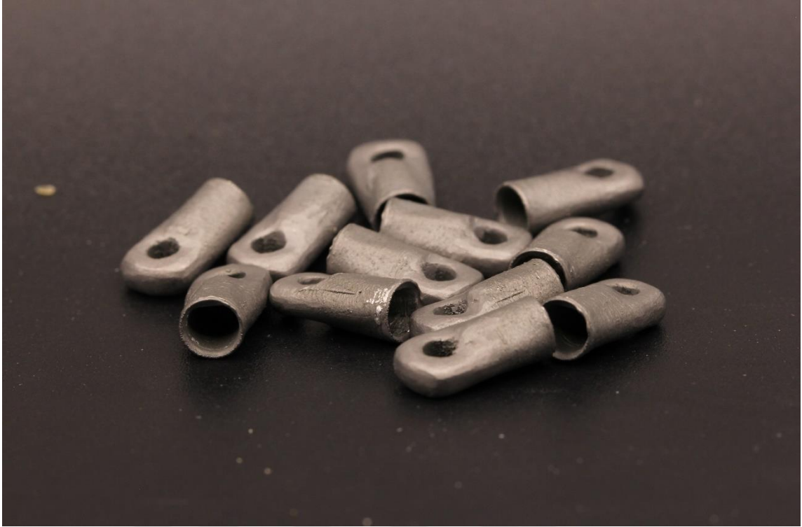
Şekil 3-20: Lazer sinterleme cihazı ile üretilen Cr-Co alaşım kuronlar
