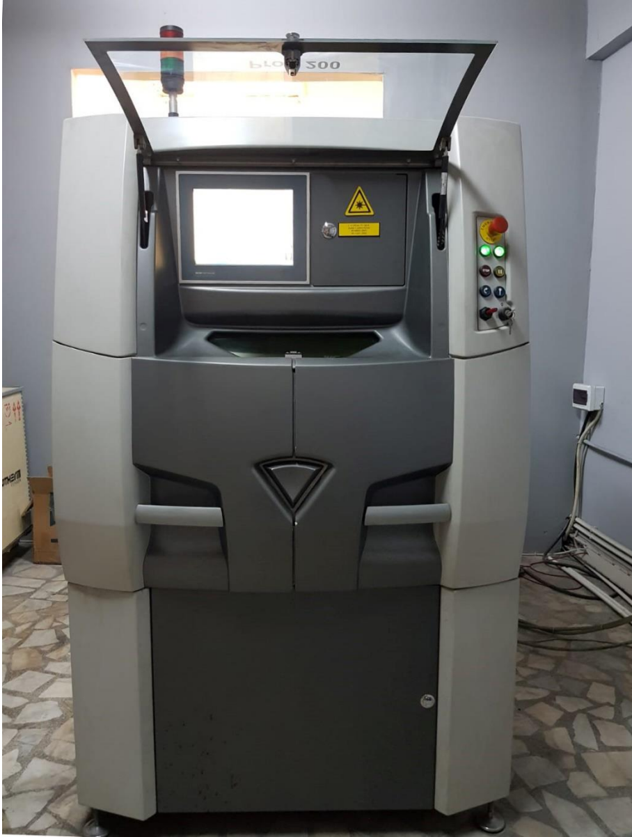
Şekil 3-19: Lazer sinterleme teknolojisine sahip bilgisayar destekli üretim sistemi (ProX DMP 200)
