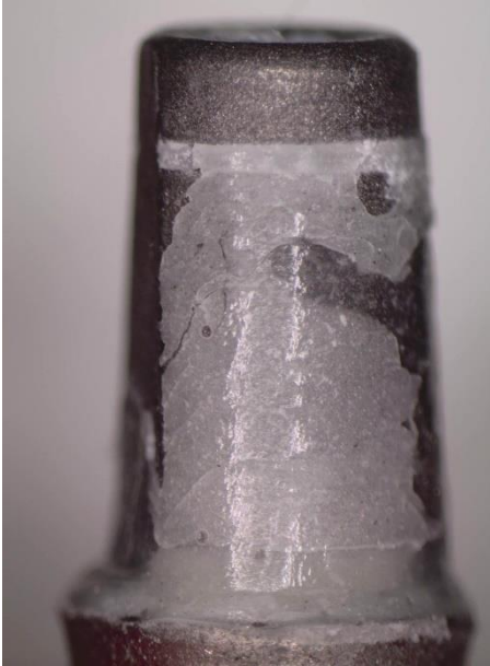
Şekil 4-23: Abutment ile kuron arasındaki koheziv tip ayrılma görüntüsü
