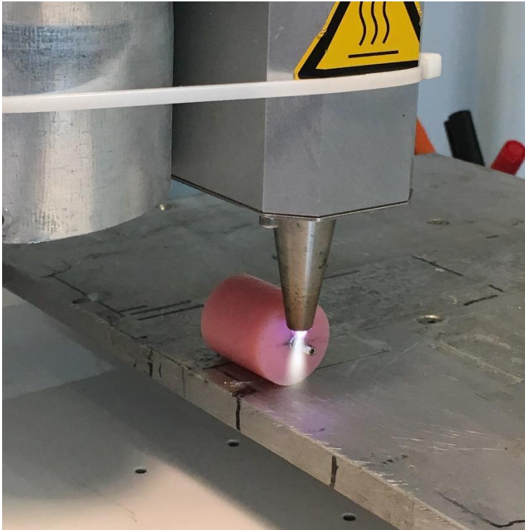
Şekil 3-9: Atmosferik plazma işlemlerinin abutment yüzeyine uygulanması
