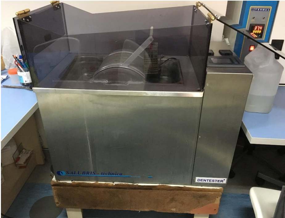
Şekil 3-25: Termal siklus cihazı (Salubris-Technica)
