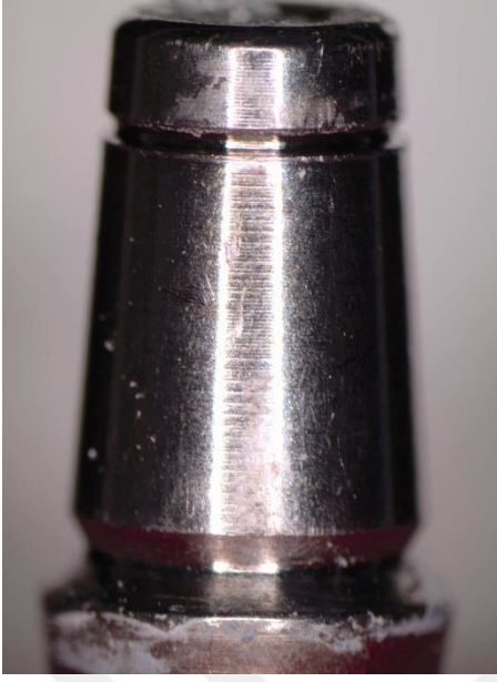
Şekil 4-22: Abutment ile kuron arasındaki adeziv tip ayrılma görüntüsü
