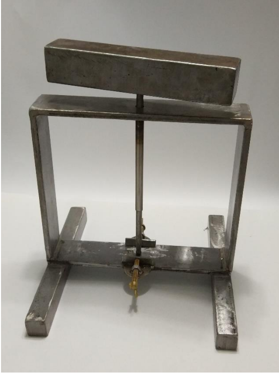
Şekil 3-24: Kuronlara 5 kg kuvvet uygulanması amacıyla hazırlanan düzenek
