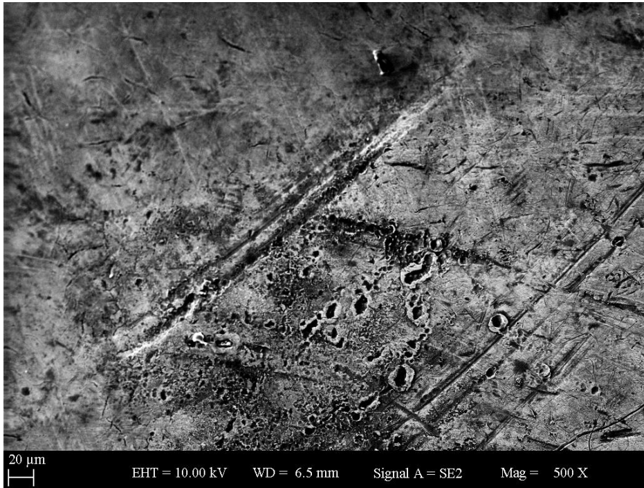
Şekil 4-14: CMP işlemi uygulanan grup örnek yüzeylerinin 500x büyütmede SEM görüntüleri
