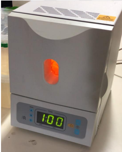
Şekil 3-12: 3 boyutlu yazıcıdan çıkan akrilik rezin blokların polimerizasyonunun tamamlanması için UV LED ışık altında bırakılması
