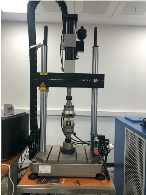
Şekil 3-15: Örneklerin Universal Test Cihazına bağlı hali
