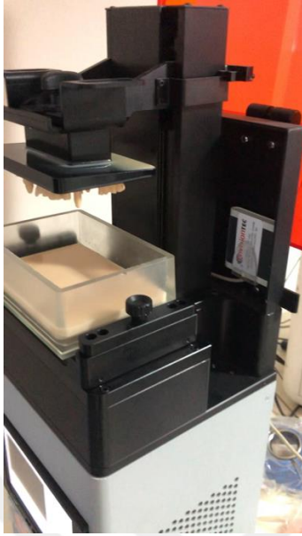
Şekil 3-11. Akrilik rezin blokların 3 boyutlu yazıcıda üretilme aşaması
