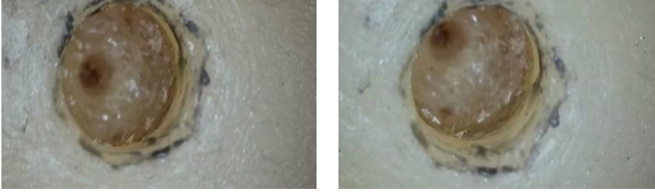
Şekil 3.41. 4265 baskı sonrası gömlekli implant montaj edilmiş kemik numunesindeki deformasyonu.
