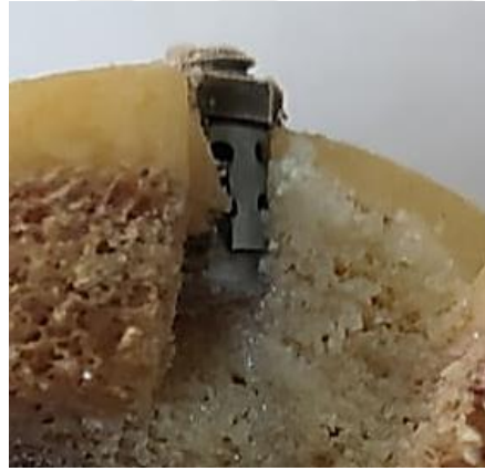
Şekil 3.16. Gömlekli implant prototipinin inek kaval kemiğine montajı.
