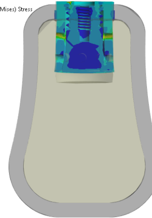
Şekil 3.32. Gömlekli implant (D1), 2954 çiğneme sayısı için FEA von Mises gerilimi (MPa) görüntüsü
