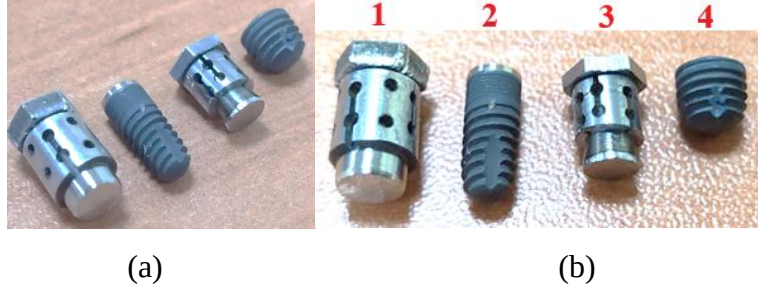
Şekil 3.15. Talaşlı imalat ile üretilen gömlekli implant ile günümüz tedavilerinde kullanılan implant şekilleri; İmplant numulerinin, (a) perspektif görüntüleri, (b) önden görünüşleri.
