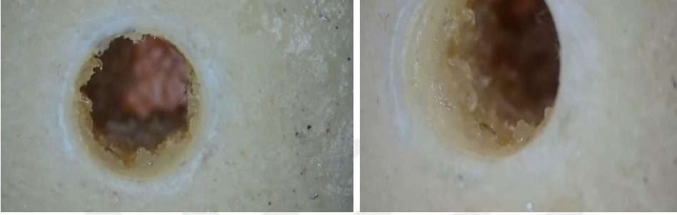
Şekil 3.42. 3100 baskı sonrası mevcut (klasik) implant montaj edilmiş kemik numunesindeki deformasyonu.
