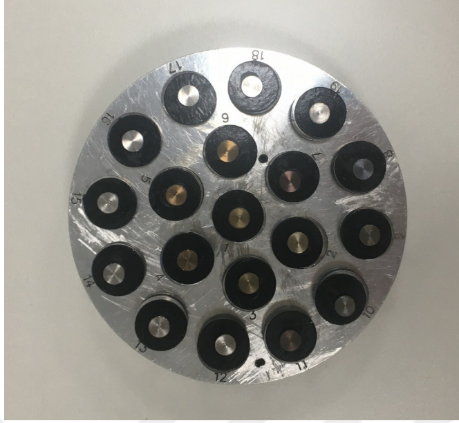
Şekil 3-18: Numunelerin SEM incelemesi için hazırlanması
