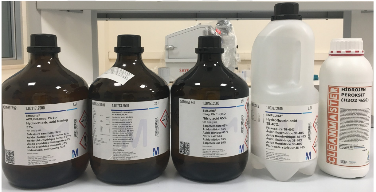
Şekil 3-4: Çalışmada kullanılan asit solüsyonları (HCl, HNO 3 , HF, H 2 SO 4 , H 2 O 2 )
