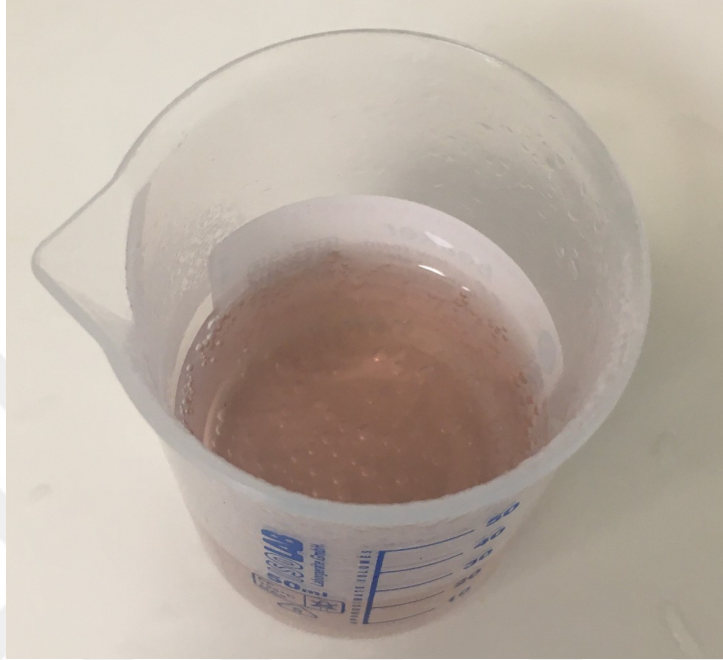
Şekil 4-1: HF ile asitlenen titanyum diskin 10 dk sonunda tamamen erimesi
