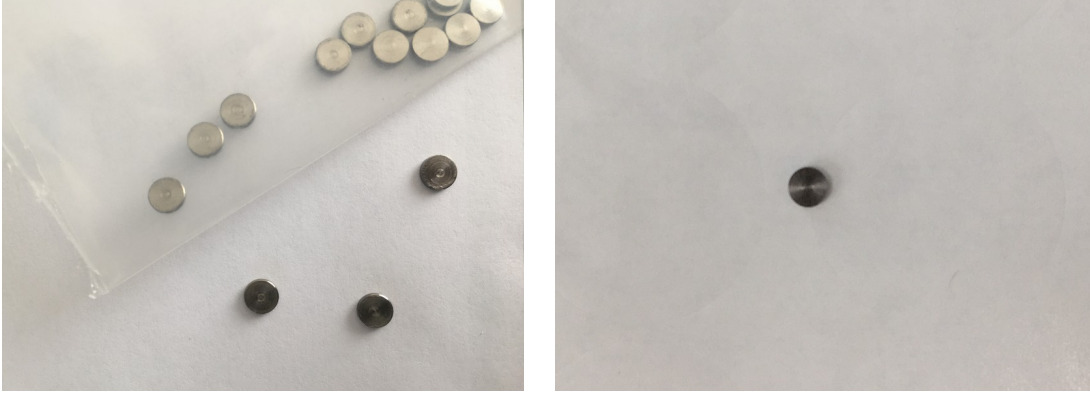
Şekil 3-3: 3mm x 5mm boyutlarında Grade 4 saf titanyum diskler
