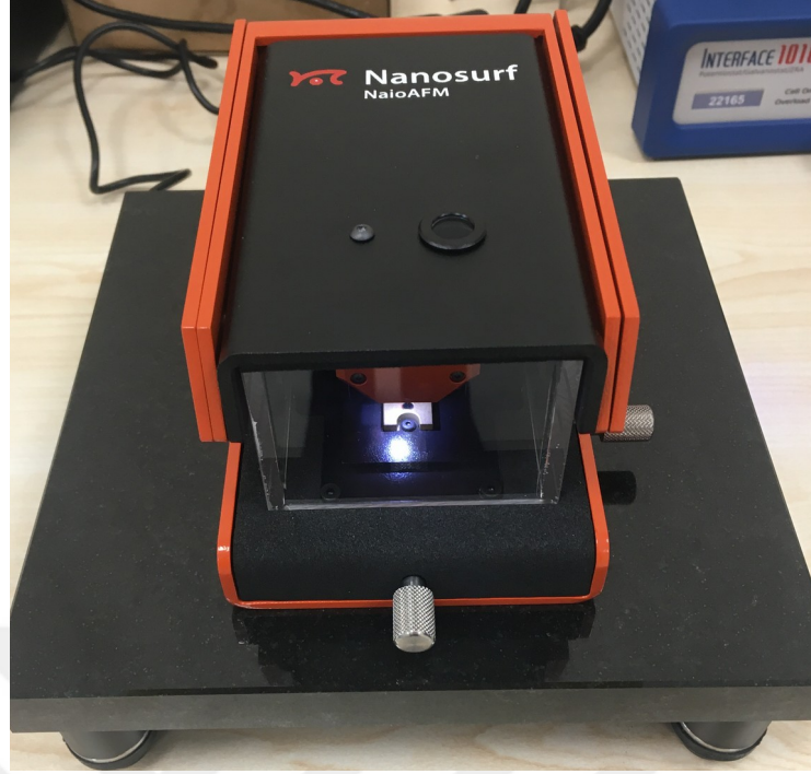
Şekil 3-14: AFM cihazı (Nanosurf-NaioAFM, Switzerland)
