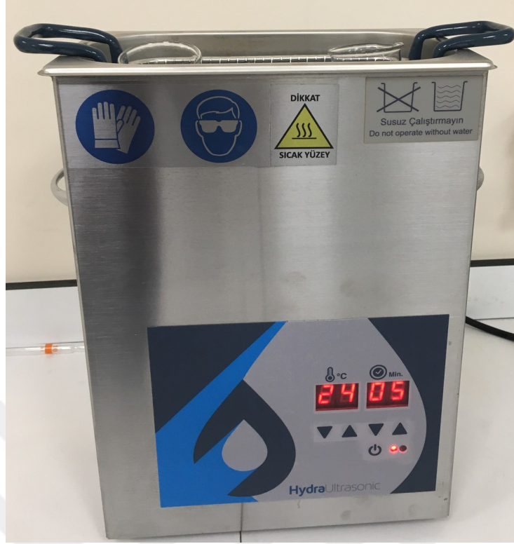
Şekil 3-12: Her bir numunenin 5 dk süreyle etil alkol içerisinde asitten temizlenmesi
