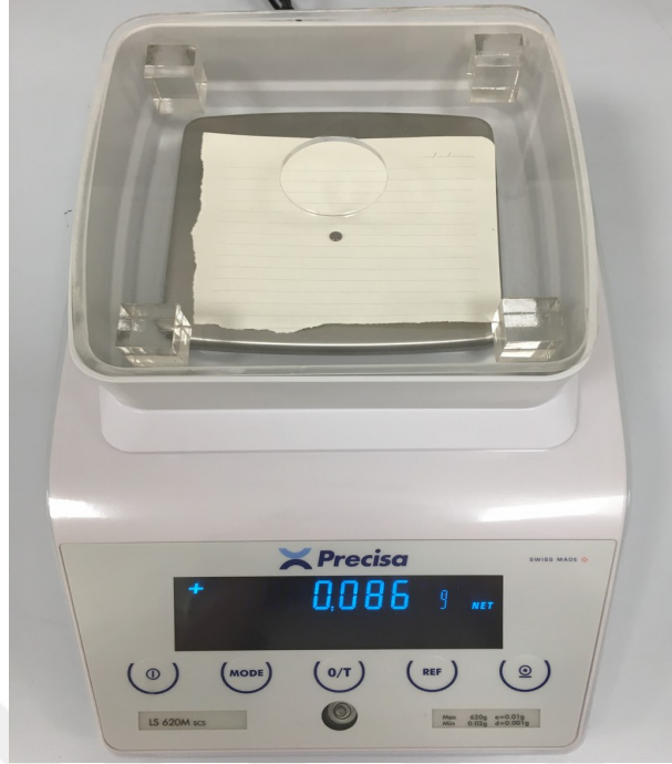
Şekil 3-6: Hassas terazi ile yapılan ağırlık ölçümleri
