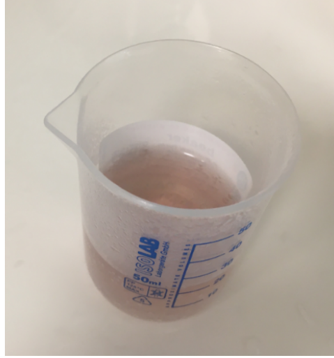
Şekil 3-8: HF ile yapılacak deneyler için plastik beher kullanımı
