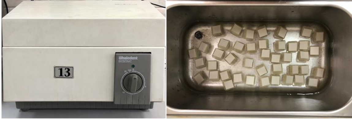
Resim 3.20. Ultrasonik temizleme cihazı ve PEKK test örnekleri
