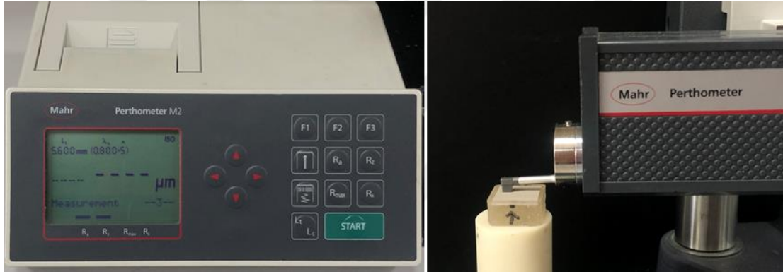
Resim 3.33. Profilometre ve PEKK test örneklerinin yüzey işlemleri sonrası yüzey pürüzlülüğü ölçümü
