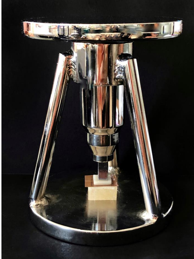
Resim 3.49. Bağlantısı sağlanan test örneklerinin yükleme aleti altında basınca maruz bırakılması
