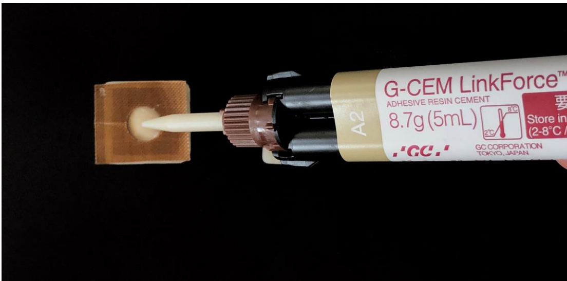
Resim 3.47. Teflon kumaş ile bağlantı yüzeyi belirlenen PEKK test örneklerine rezin siman uygulanması
