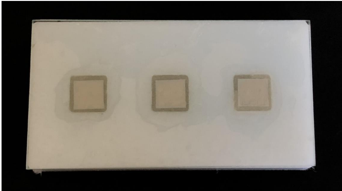
Resim 3.17. Akrilik ile doldurulmuş kalıba PEKK test örneklerinin yerleştirilmesi ve camın kalıp üzerinde sabitlenmesi
