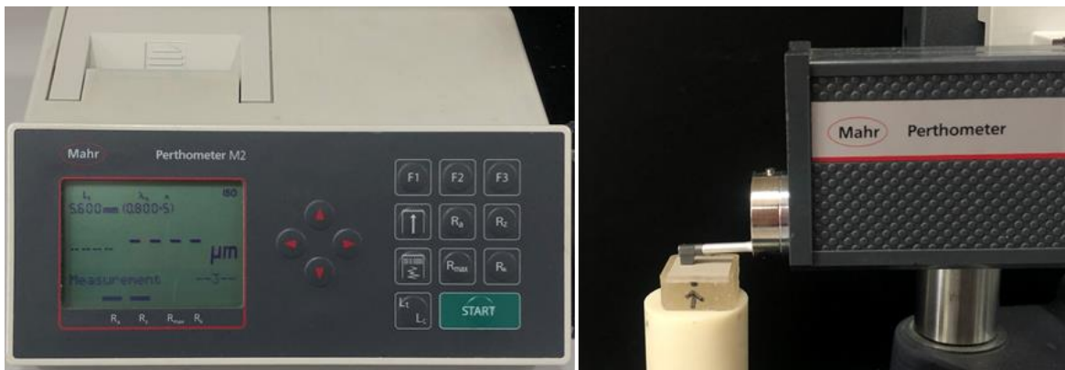
Resim 3.21. Profilometre ve PEKK test örneklerinin yüzey işlemleri öncesi yüzey pürüzlülüğü ölçümü
