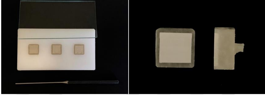
Resim 3.18. Polimerizasyon sonrası örneklerin kavite merkezinde yer alan delikten itilerek kalıptan çıkartılması ve akrilik bloğa gömülü PEKK test örneklerinin elde edilmesi
