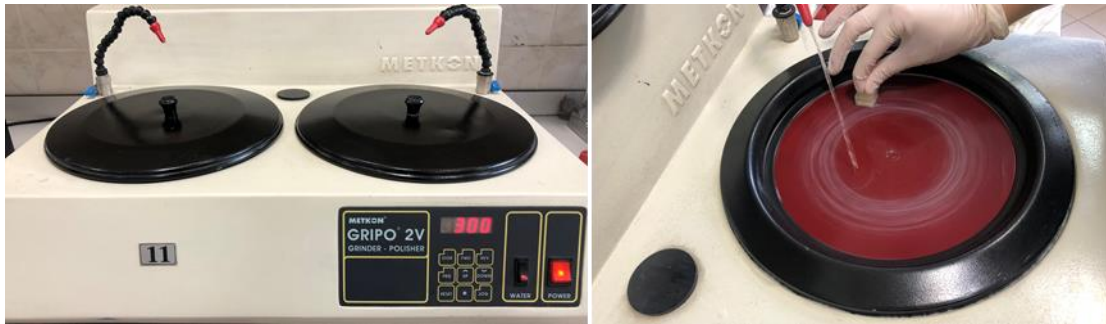
Resim 3.19. Zımparalama/polisaj cihazı ve PEKK test örneklerinin yüzeyinin polisajlanması
