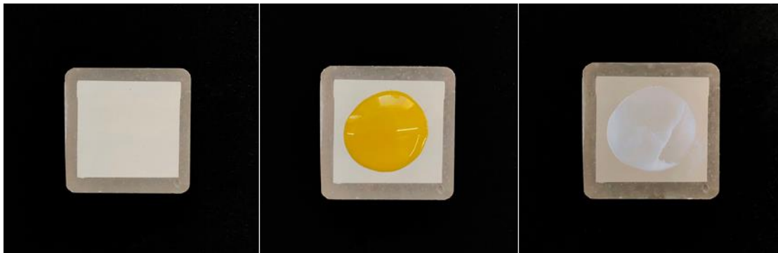
Resim 3.30. C grubunun PEKK test örneği üzerine piranha solüsyonu uygulaması
