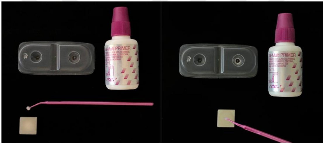
Resim 3.43. Lityum disilikat cam seramik test örneklerinin bağlantı yüzeylerine silan içerikli primer uygulanması
