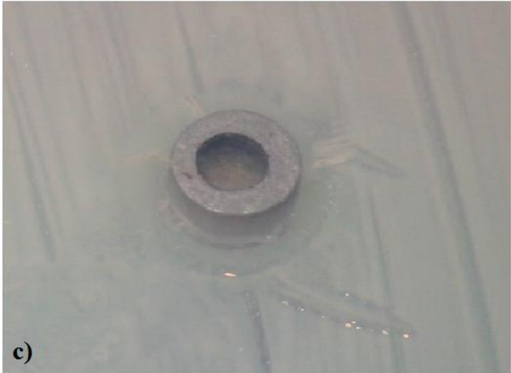
Şekil 4.25. Çeşitli bakteri kolonilerine karşı yapılan antibakteri testlerinin fotoğrafları a) NiTi kontrol numunesi ( P.aeruginosa bakterisine karşı) b) MAO kaplanmış NiTi numunesi ( P.aeruginosa bakterisine karşı) c) Nano Ag ilaveli MAO kaplı NiTi numunesi ( P.aeruginosa bakterisine karşı)
