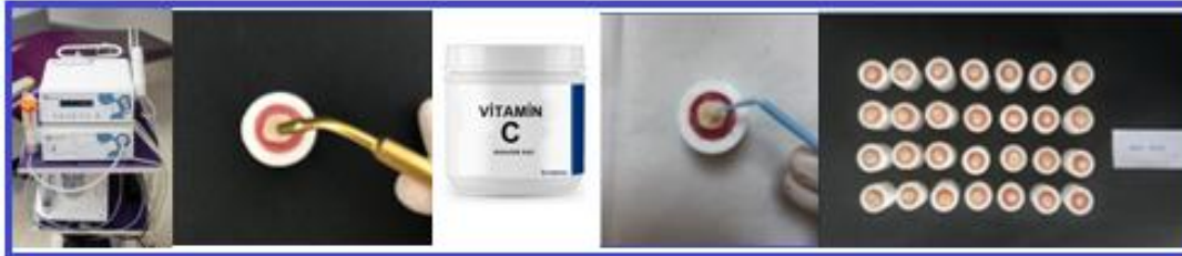
Resim 3.18. Baęlanma dayanımı grup 4’de (ozon grubu) kullanılan ozon jeneratörü ( OzonyTronX ® ) ve uygulaması
