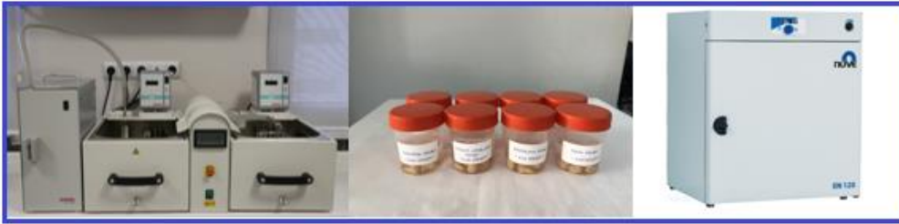
Resim 3.9. İki yıl yaşlandırma protokolü; 5-55 °C, 10 sn / 10.000 termal siklusu takiben 1 yıl süre ile etüvde ( Nüve Incubator EN 120 , Türkiye) bekletilen örnekler
