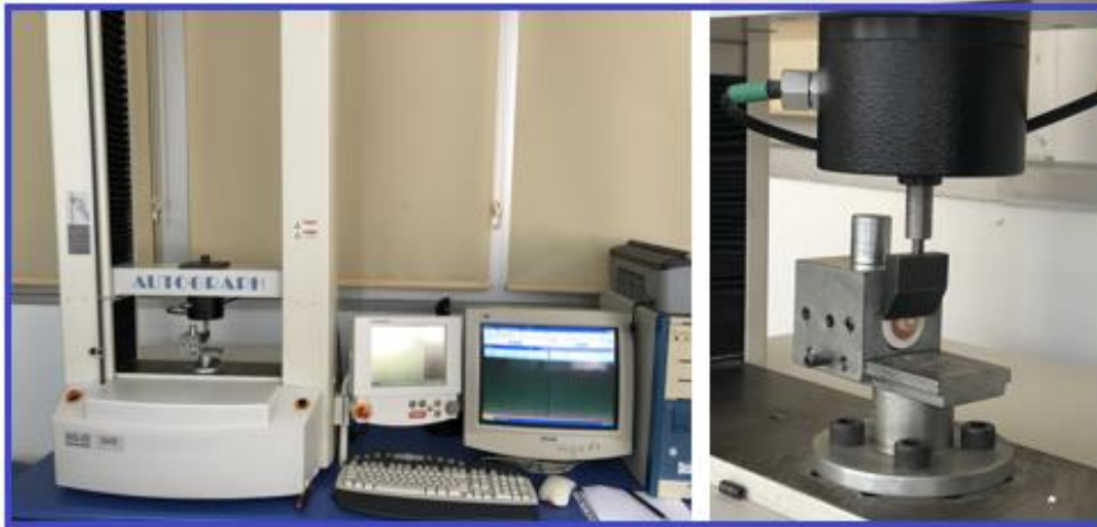
Resim 3.19. Makro-makaslama testi için kullanılan Shimadzu AG-IS Autograph (Shimadzu Scientific Instruments, Amerika) cihazı
