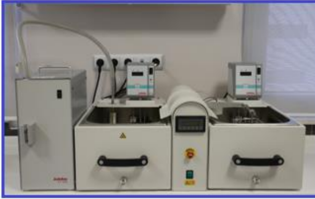
Resim 3.8. Bir yıl yaşlandırma protokolü; 5-55 °C, 10 sn/10.000 termal siklus cihazı ( SD Mechatronik Thermocycler cihazı, Almanya)
