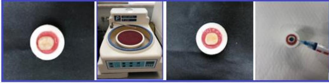
Resim 3.14. Bağlanma dayanım testi örneklerinin yüzey hazırlığı aşamaları ( Presi Mepacol P230 )
