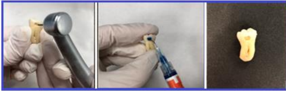
Resim 3.2. Mikrosızıntı testi için kullanılacak dişte servikal kavitenin hazırlanması ve asitle pürüzlendirme işleminin tamamlanması
