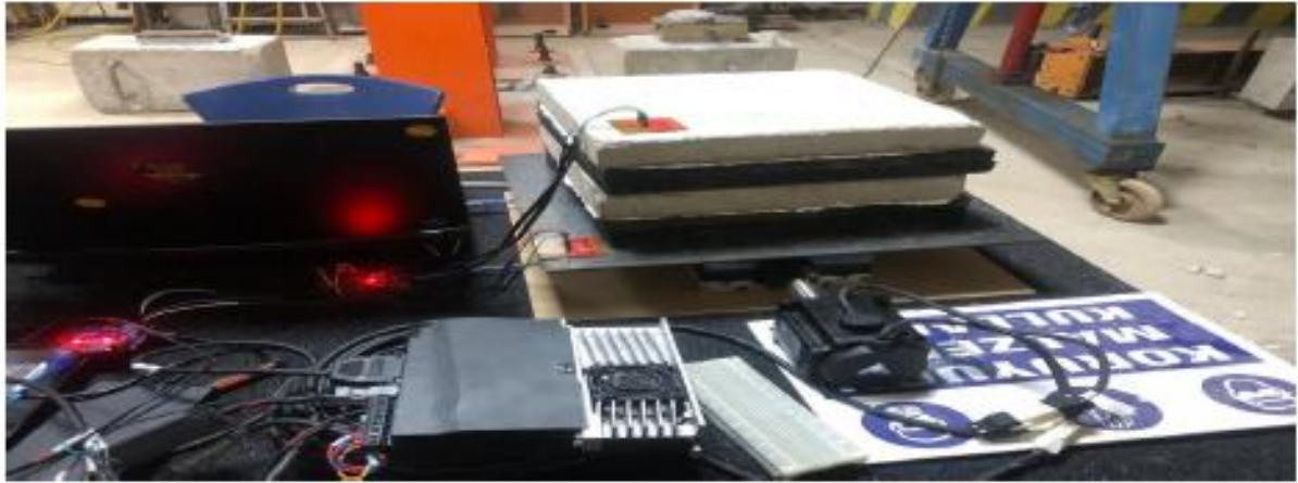
Şekil 12. 1D Meta-Malzeme periyodik temel, kauçuk ve beton katmanlarından oluşmaktadır. Servo motor, kontrol ünitesi ve ivmeölçerin bilgisayara bağlantı düzeneği
