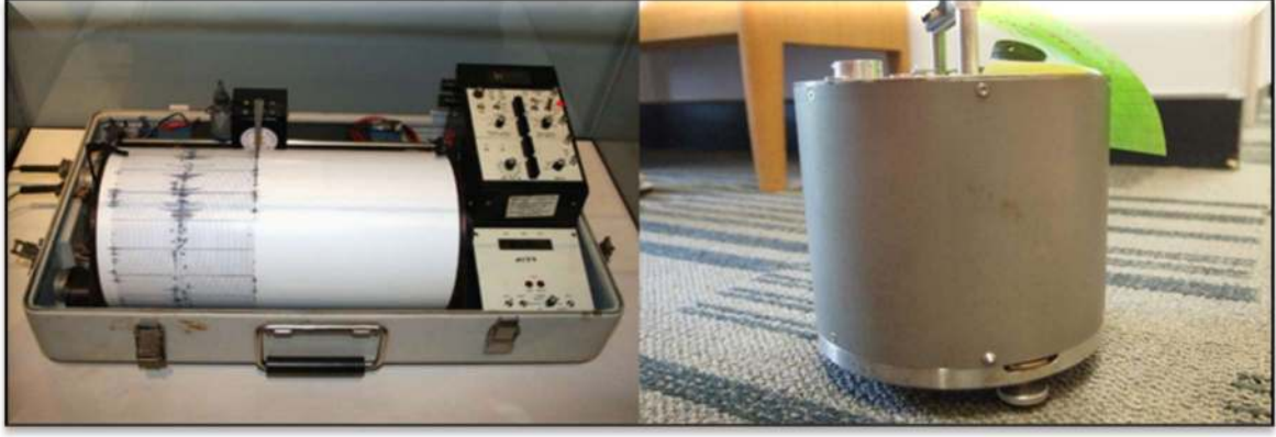
Şekil 2.1 Kinematik Sismograf ve Üç Eksenli Geniş Bant Sismograf (URL-2).
