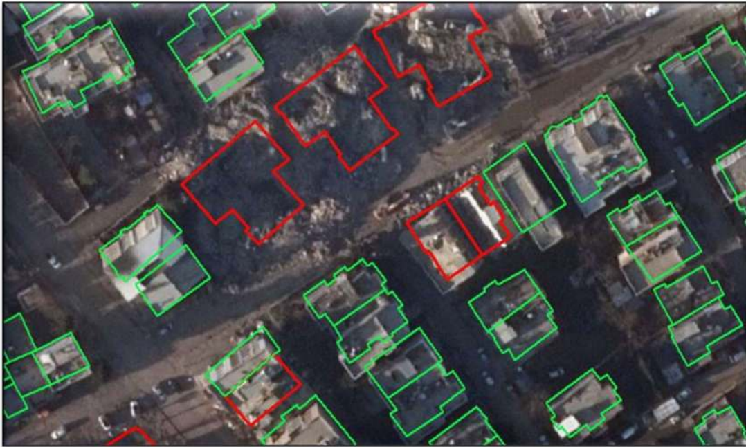
Şekil 4.19 Yıkılan ve Yıkılmayan Binaların Birlikte Görünümü (ds-GÖR).
