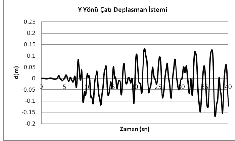
Şekil 5.32 P0170 Imperial Valley depremi Y doğrultusu tepe yatay yerdeğiştirme-zaman grafiği
