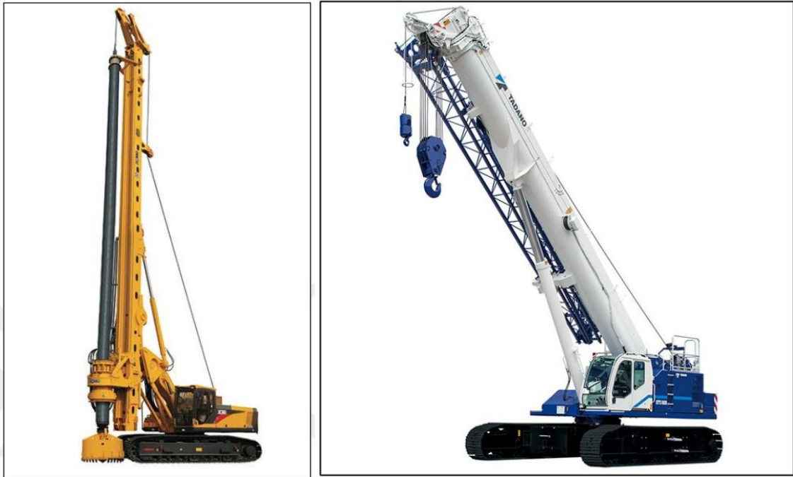
Görsel 2.2. Fore kazık makinesi ve servis vinci
