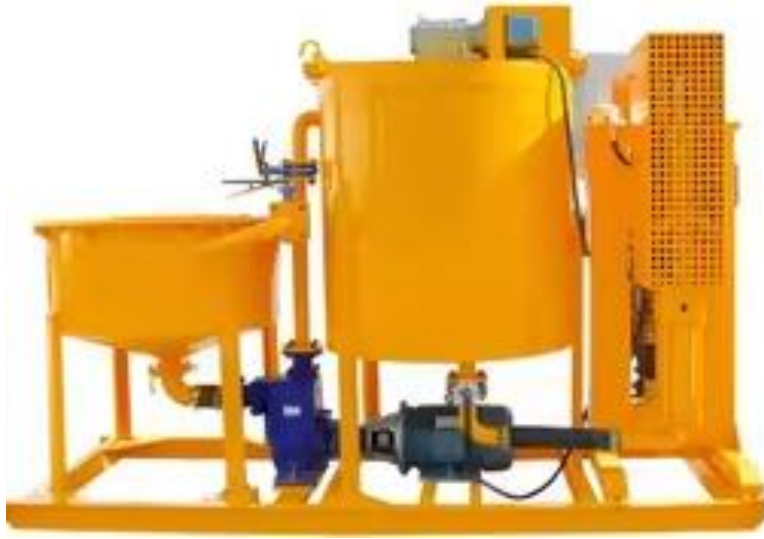
Görsel 3.9. Enjeksiyon pompası
