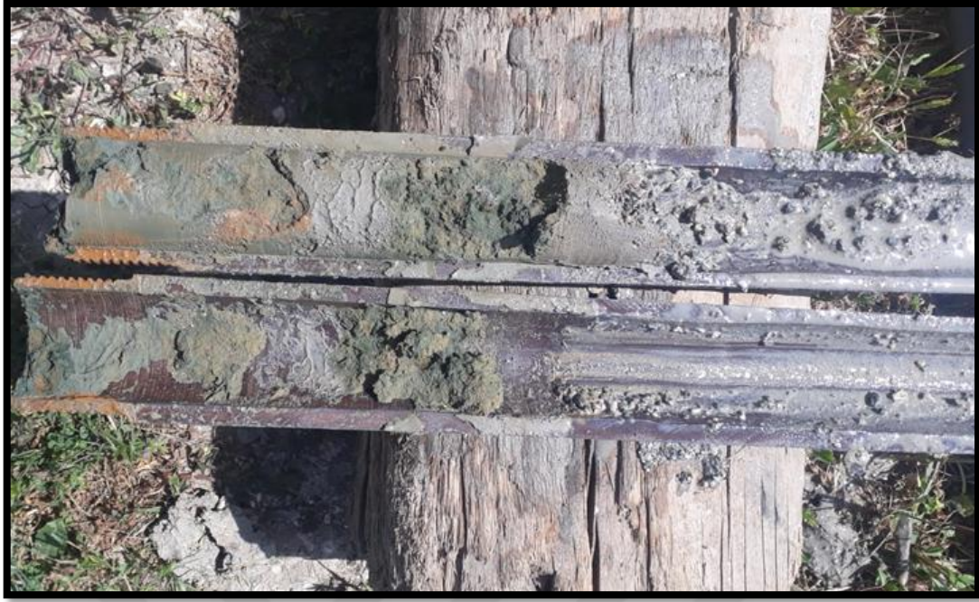
Görsel 3.5. Dış çaplı ve 1 3/8 iç çaplı yarık numune alıcı
