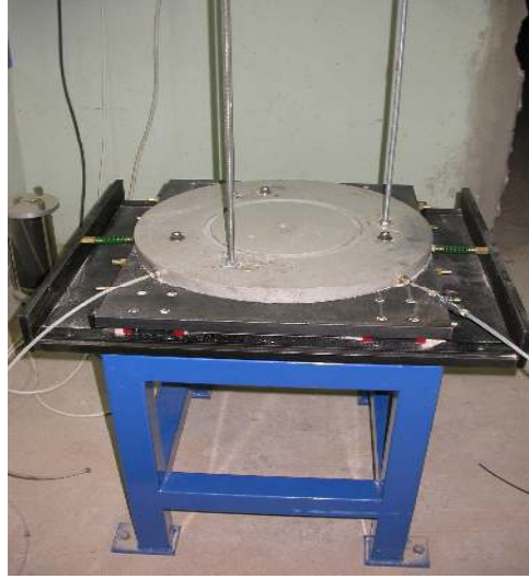
Şekil 5.5 Sarsma Tablasının Görünümü
