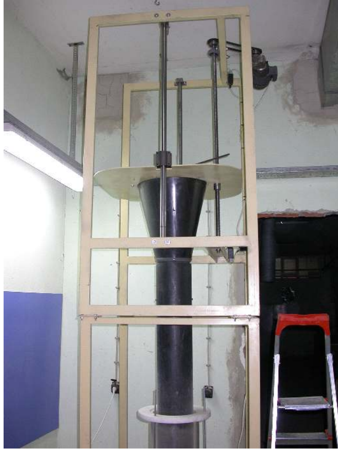
Şekil 5.7. Kum Yağmurlama Sistemi
