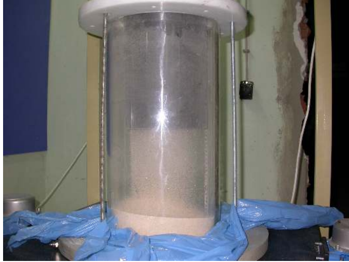
Şekil 5.8. Kumun Pleksiglas Silindir İçerisine Yağmurlanması
