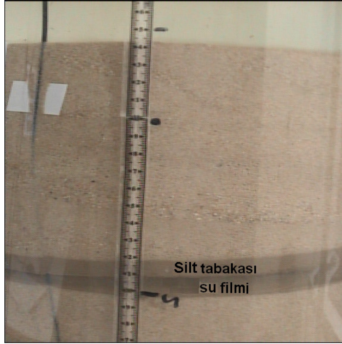
Şekil 5.45 Geçirimliliği daha düşük silt tabakası altında oluşan su filmi
