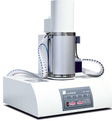
Şekil 4.10. Linseis LFA 1000 lazer flaş ısıl yayılım katsayı analiz cihazı [70].
