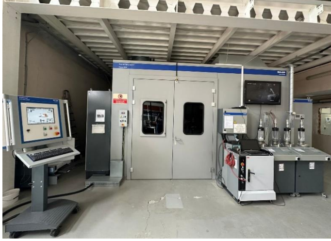
Şekil 4.6. Kaplama Üretim Sistemi.
