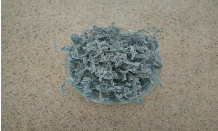
Resim 3. 1 kromla tabaklanmış deri atıkları.
