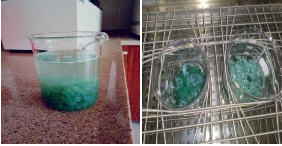
Resim 3. 2 Deri atıklarının fosforik asit ile etkileştirilmesi.
