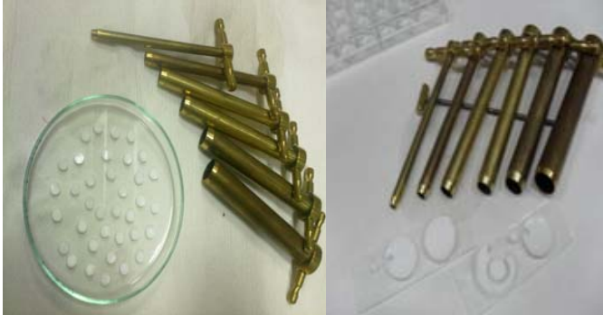
Şekil 3.2. p(HEMA-GMA) Hidrojel Membranın Kesilmesi.
