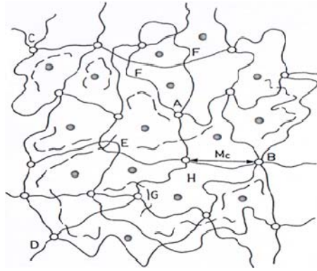
Şekil 2.4. Çapraz bağlı hidrojinin yapısı (Bakraktar, 2013).
