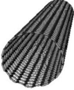
Görsel 2.4. Tek Duvarlı Karbon Nanotüp (Purohit, 2014:716-728)
