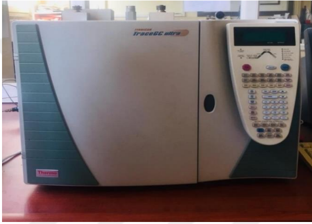
Şekil 3.11. Solunum hızı ve etilen ölçümleri için kullanılan Gaz kromatografi (GC) cihazı
