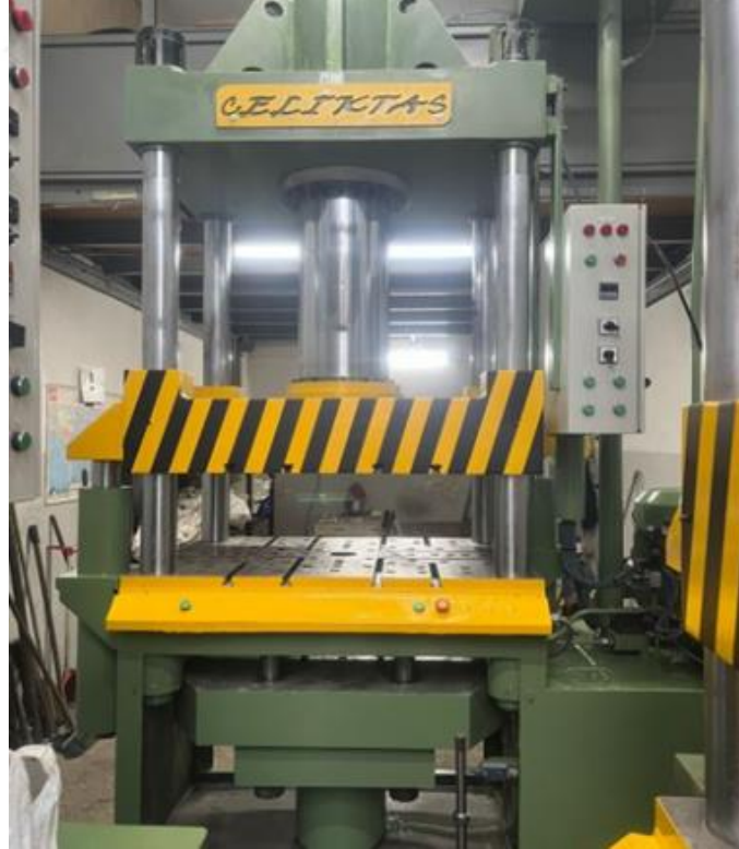
Fotoğraf 3.2. Tek Tesirli Hidrolik Pres
