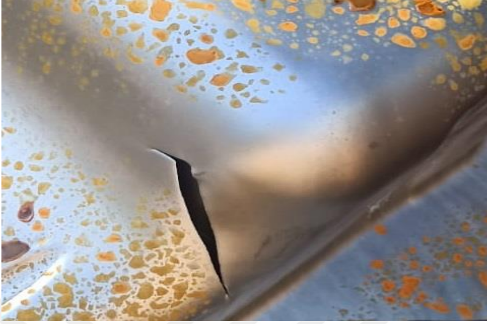
Fotoğraf 5.15. Dc04 Kalite 0,7 mm Sac Kalınlık Denemesi
