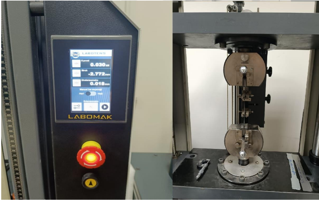
Fotoğraf 5.5. Çekme Test Ekipmanı
