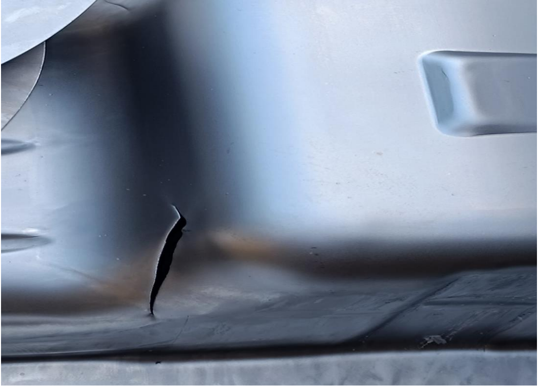
Fotoğraf 5.14. Dc04 Kalite 0,67 mm Sac Kalınlık Denemesi
