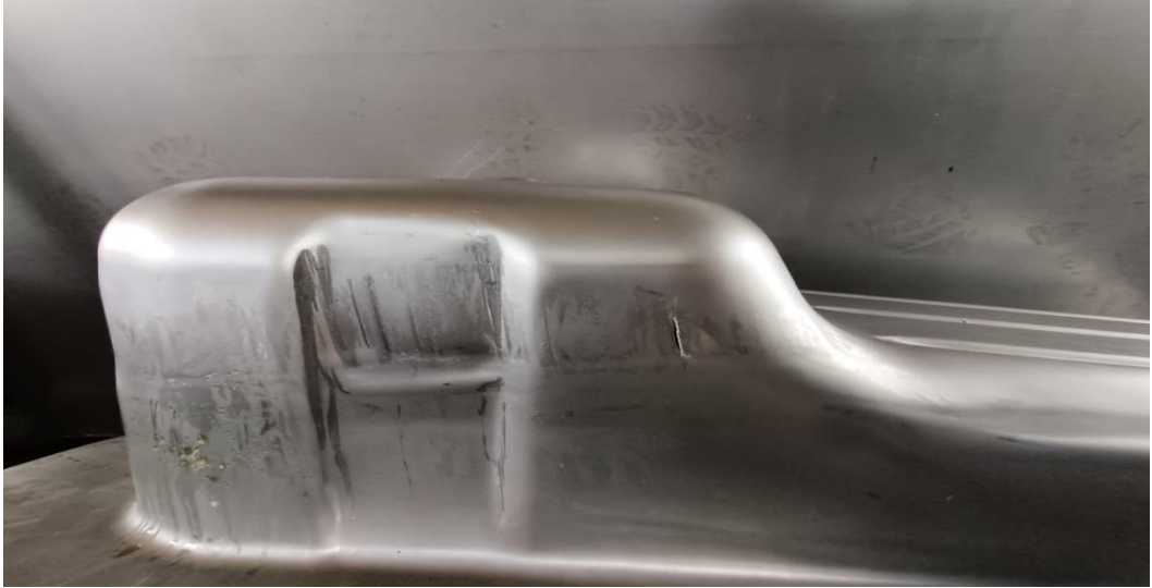
Fotoğraf 5.20. Dc04 0,95 mm Sac Kalınlık Denemesi
