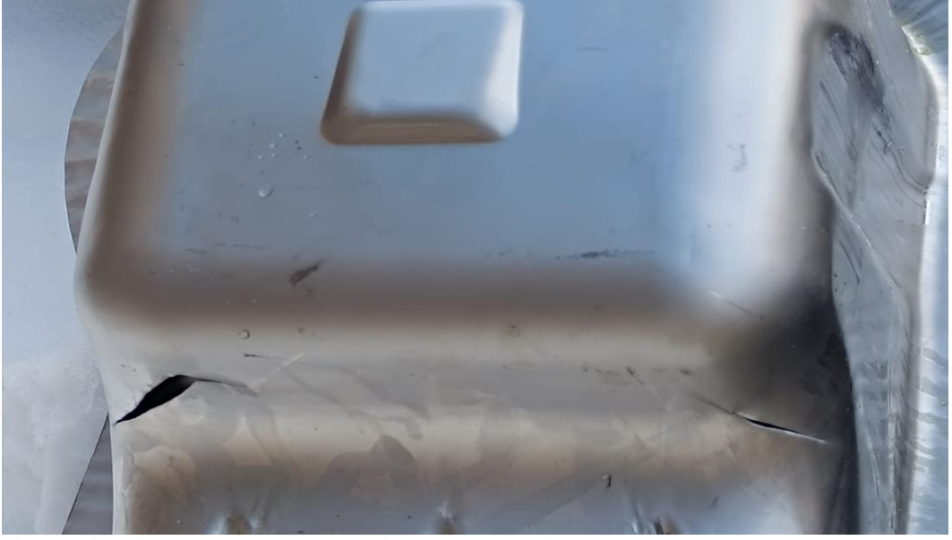
Fotoğraf 5.13. Dc04 Kalite 0,6 mm Sac Kalınlık Denemesi
