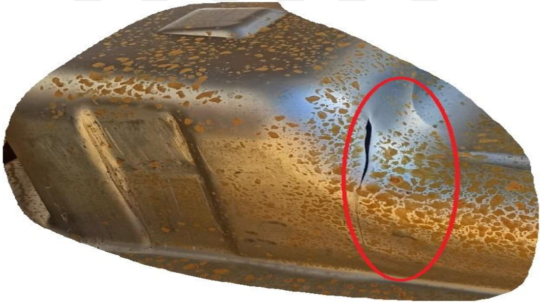
Fotoğraf 5.18. Dc01 0,86 mm Sac Kalınlık Denemesi
