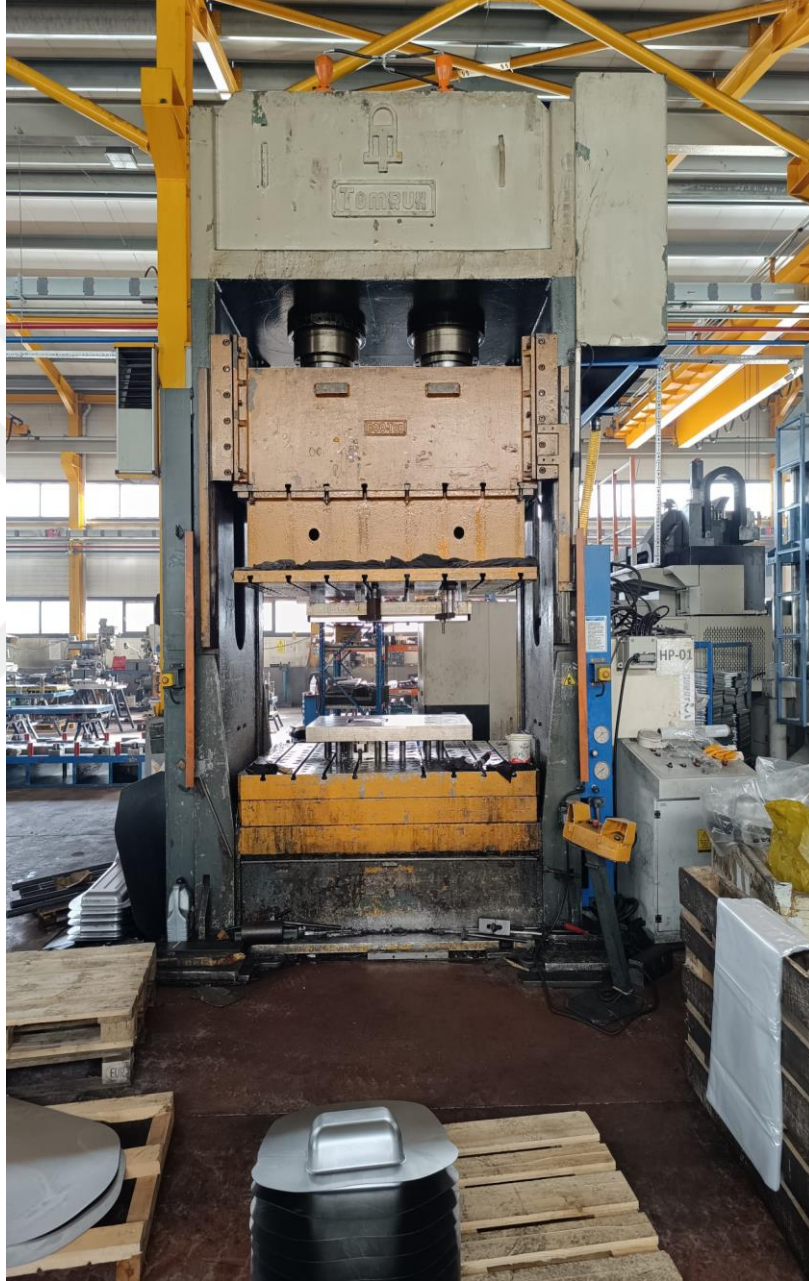
Fotoğraf 5.8. 600 Ton Hidrolik Pres ve İlk Operasyon
