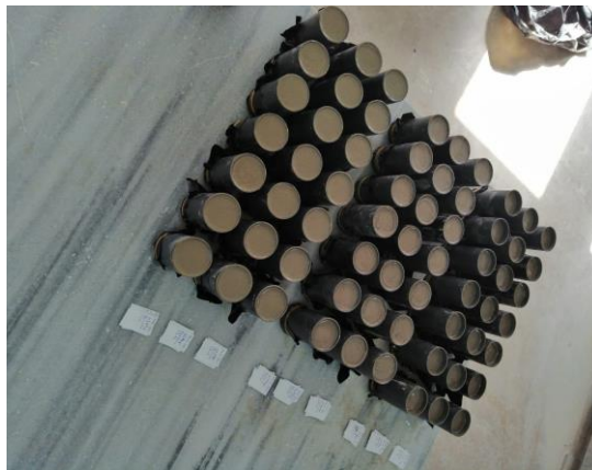
Şekil 3.69. Mikserle karıştırılan zemin-bağlayıcı numunelerinin kalıba yerleştirilmesi
