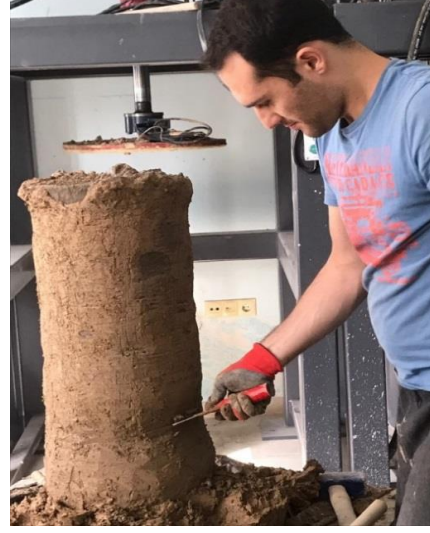
Şekil 3.26. İmal edilen ilk derin karıştırma kolonu (deneme kolonu)
