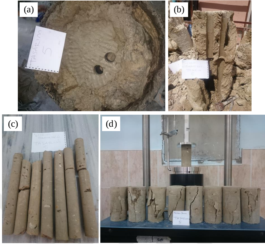
Şekil 3.39. SP-5 numaralı DKK: a) imalat sonrası görünüm, b) kolon iç yapısı, c) alınan karot numuneleri, d) UCS deneyindeki kayma yüzeyi (Sistem parametrelerinin araştırılması)
