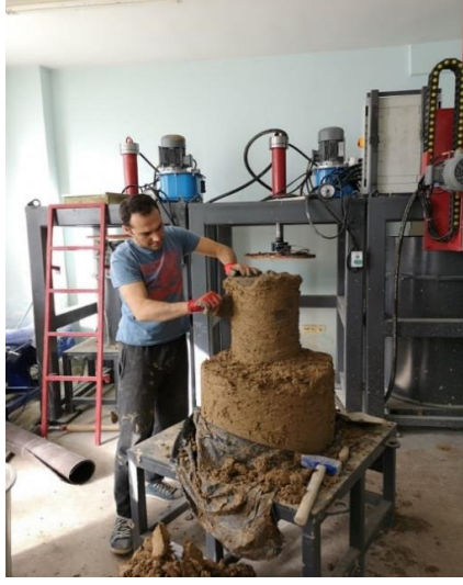
Şekil 3.26. İmal edilen ilk derin karıştırma kolonu (deneme kolonu)
