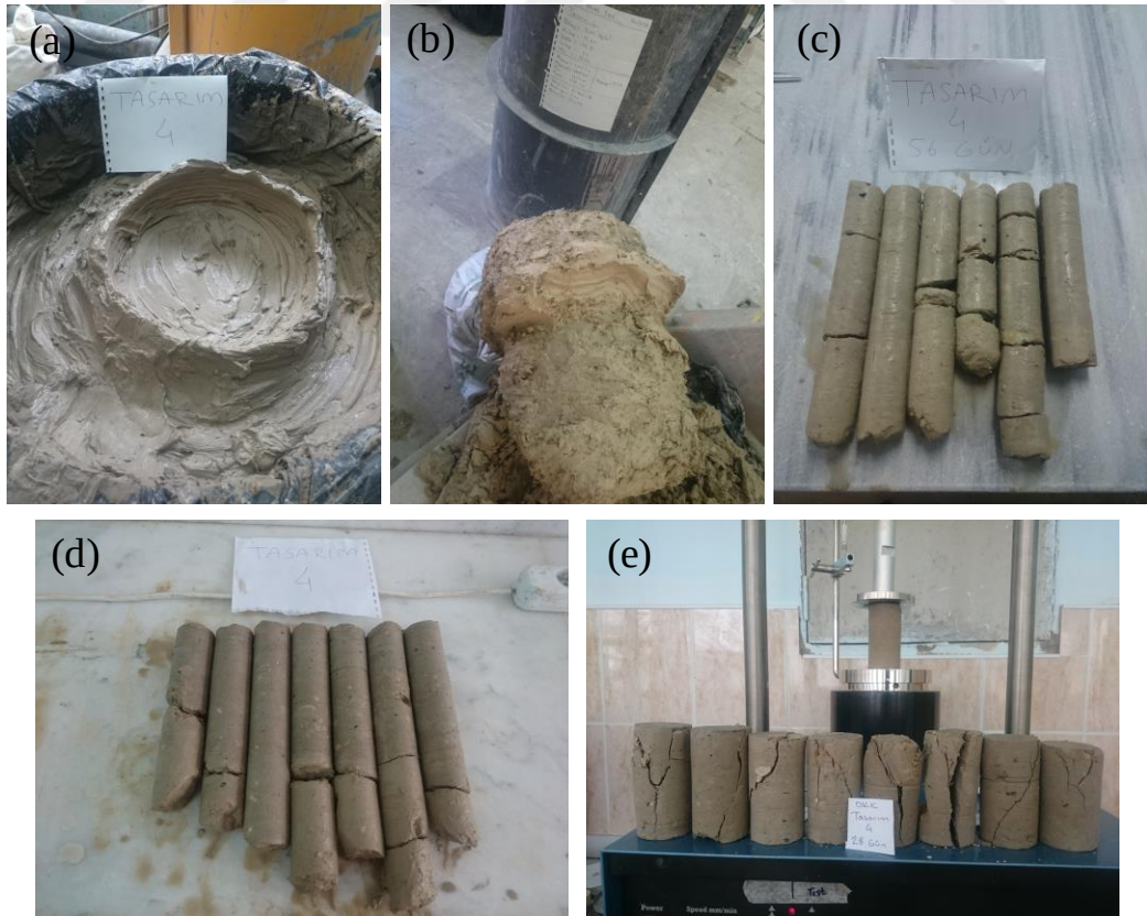
Şekil 3.55. Büyük ölçekli DKK, Tasarım 4: a) imalat sonrası görünüm, b) imal edilen kolon, c) 56 ve d) 28 günlük karot numuneleri, e) kayma yüzeyleri (büyük ölçekli DKK)
