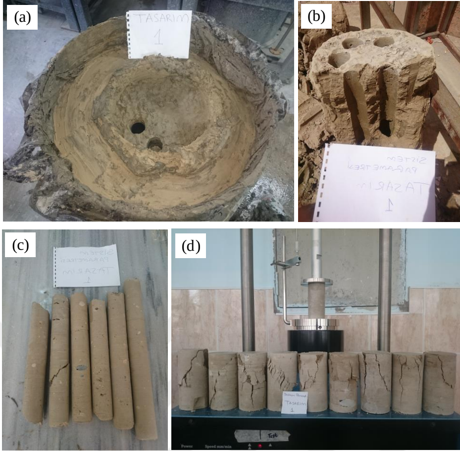
Şekil 3.35. SP-1 numaralı DKK: a) imalat sonrası görünüm, b) kolon iç yapısı, c) alınan karot numuneleri, d) UCS deneyindeki kayma yüzeyi (Sistem parametrelerinin araştırılması)
