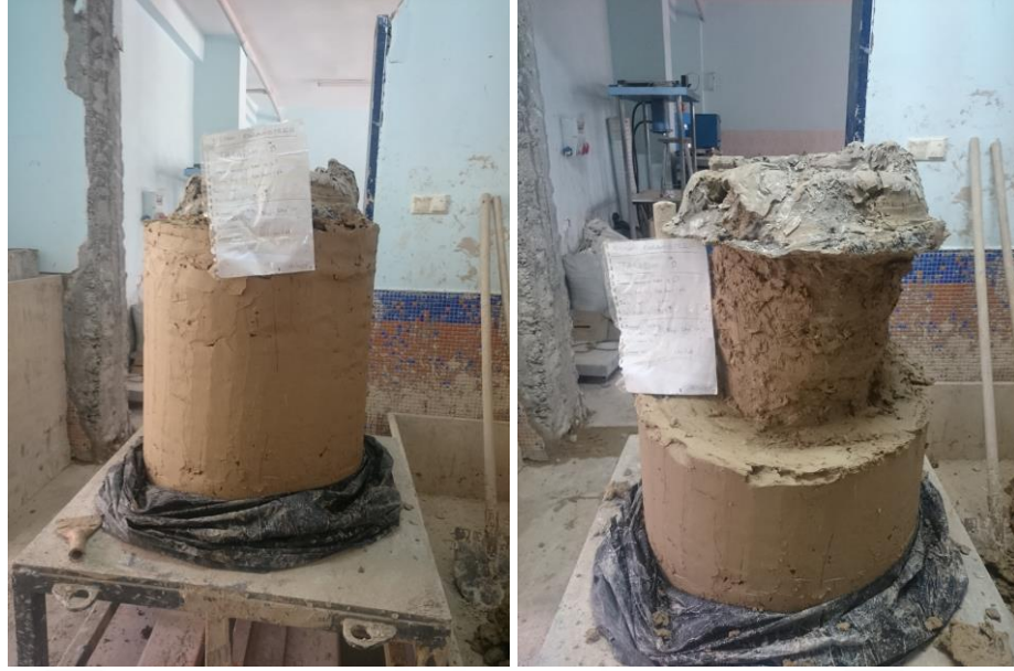
Şekil 3.34. Homojen zemin ortamının elde edilmiş hali
