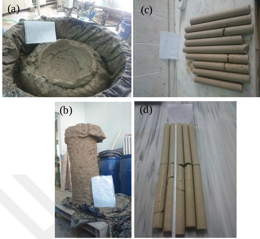
Şekil 3.64. Büyük ölçekli DKK, Tasarım 13: a) imalat sonrası görünüm, b) imal edilen kolon, c) 28 ve d) 56 günlük karot numuneleri (büyük ölçekli DKK)
