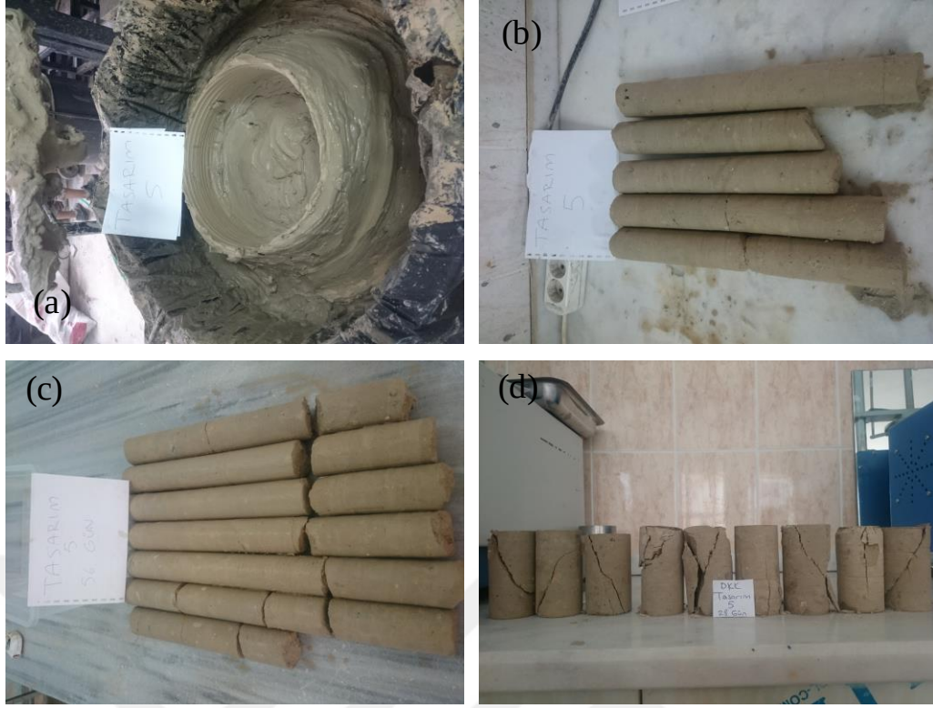
Şekil 3.56. Büyük ölçekli DKK, Tasarım 5: a) imalat sonrası görünüm, b) 28 ve c) 56 günlük karot numuneleri, d) kayma yüzeyleri (büyük ölçekli DKK)
