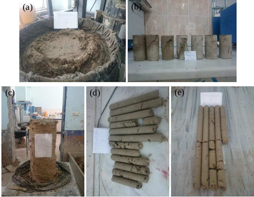
Şekil 3.58. Büyük ölçekli DKK, Tasarım 7: a) imalat sonrası görünüm, b) kayma yüzeyleri, c) imal edilen kolon, d) 28 ve e) 56 günlük karot numuneleri (büyük ölçekli DKK)
