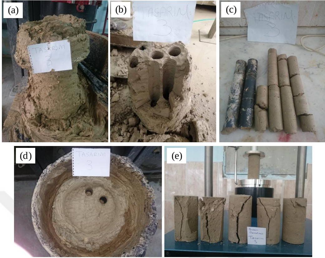
Şekil 3.37. SP-3 numaralı DKK: a) imal edilen kolon, b) kolon iç yapısı, c) alınan karot numuneleri, d) imalat sonrası görünüm, e) UCS deneyindeki kayma yüzeyi (Sistem parametrelerinin araştırılması)
