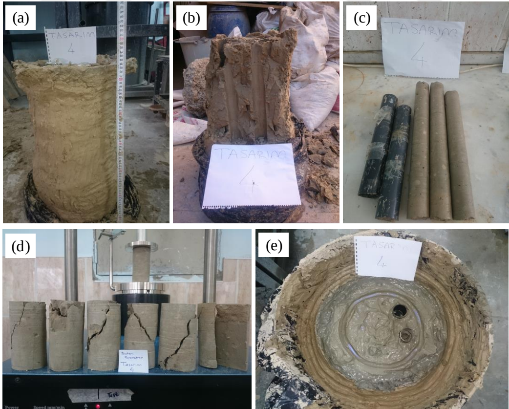
Şekil 3.38. SP-4 numaralı DKK: a) imal edilen kolon, b) kolon iç yapısı, c) alınan karot numuneleri, d) UCS deneyindeki kayma yüzeyi, e) imalat sonrası görünüm (Sistem parametrelerinin araştırılması)
