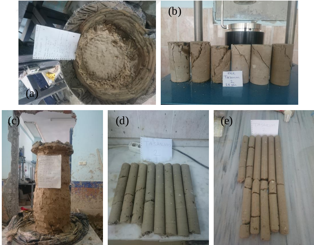
Şekil 3.53. Büyük ölçekli DKK, Tasarım 2: a) imalat sonrası görünüm, b) kayma yüzeyleri, c) imal edilen kolon, d) 28 ve e) 56 günlük karot numuneleri (büyük ölçekli DKK)
