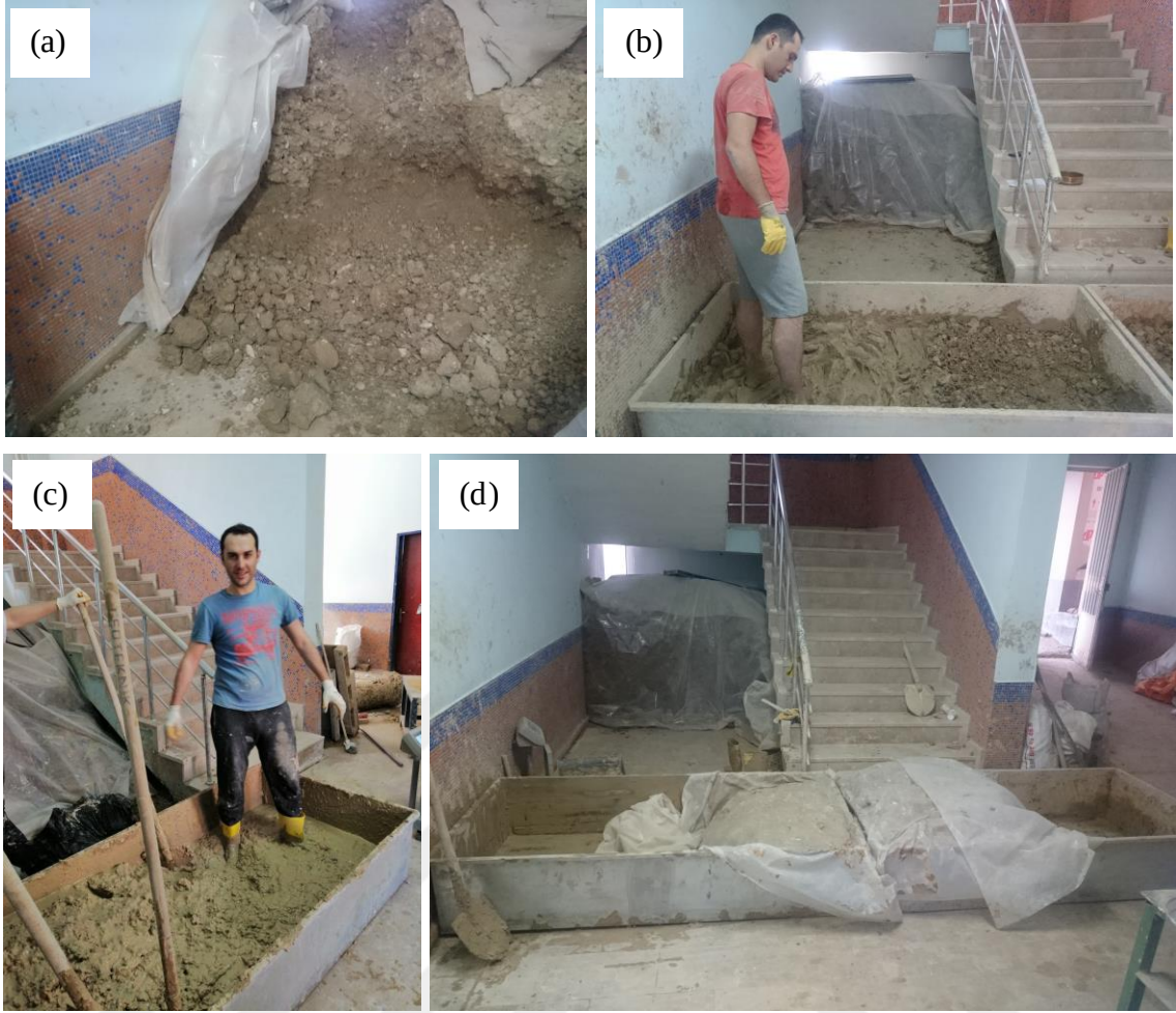
Şekil 3.32. Zeminin hedef su muhtevasında karıştırılması: a) araziden hafriyatla getirilen topaklı zemin, b) zeminin %35 su muhtevasında çığnenerek karıştırılması, c) zeminin %52 su muhtevasında çığnenerek karıştırılması ve d) zeminin üzerinin poşetle örtülerek kür edilmesi
