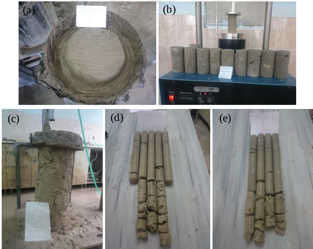
Şekil 3.59. Büyük ölçekli DKK, Tasarım 8: a) imalat sonrası görünüm, b) kayma yüzeyleri, c) imal edilen kolon, d) 28 ve e) 56 günlük karot numuneleri (büyük ölçekli DKK)
