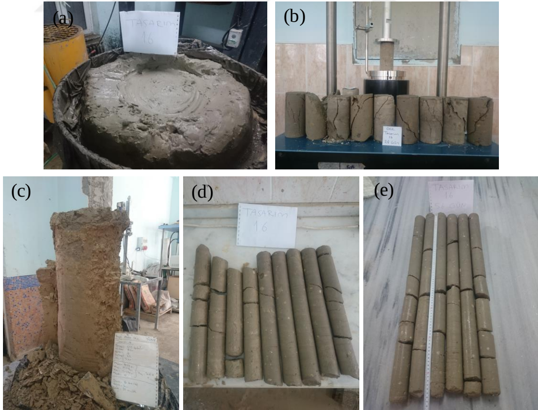
Şekil 3.67. Büyük ölçekli DKK, Tasarım 16: a) imalat sonrası görünüm, b) kayma yüzeyleri, c) imal edilen kolon, d) 28 ve e) 56 günlük karot numuneleri (büyük ölçekli DKK)
