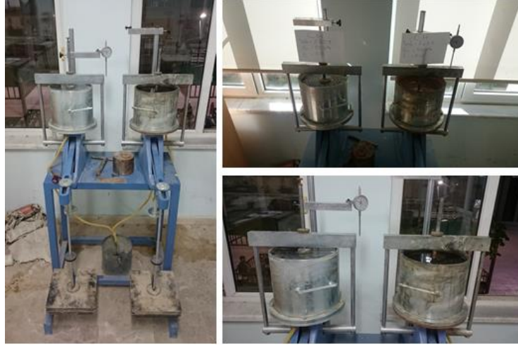
Şekil 3.30. Zeminin su muhtevası-ön konsolidasyon basıncı ilişkisinin 1/30 ölçekte araştırılması
