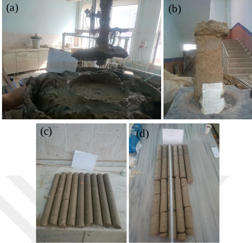
Şekil 3.66. Büyük ölçekli DKK, Tasarım 15: a) imalat sonrası görünüm, b) imal edilen kolon, c) 28 ve d) 56 günlük karot numuneleri (büyük ölçekli DKK)
