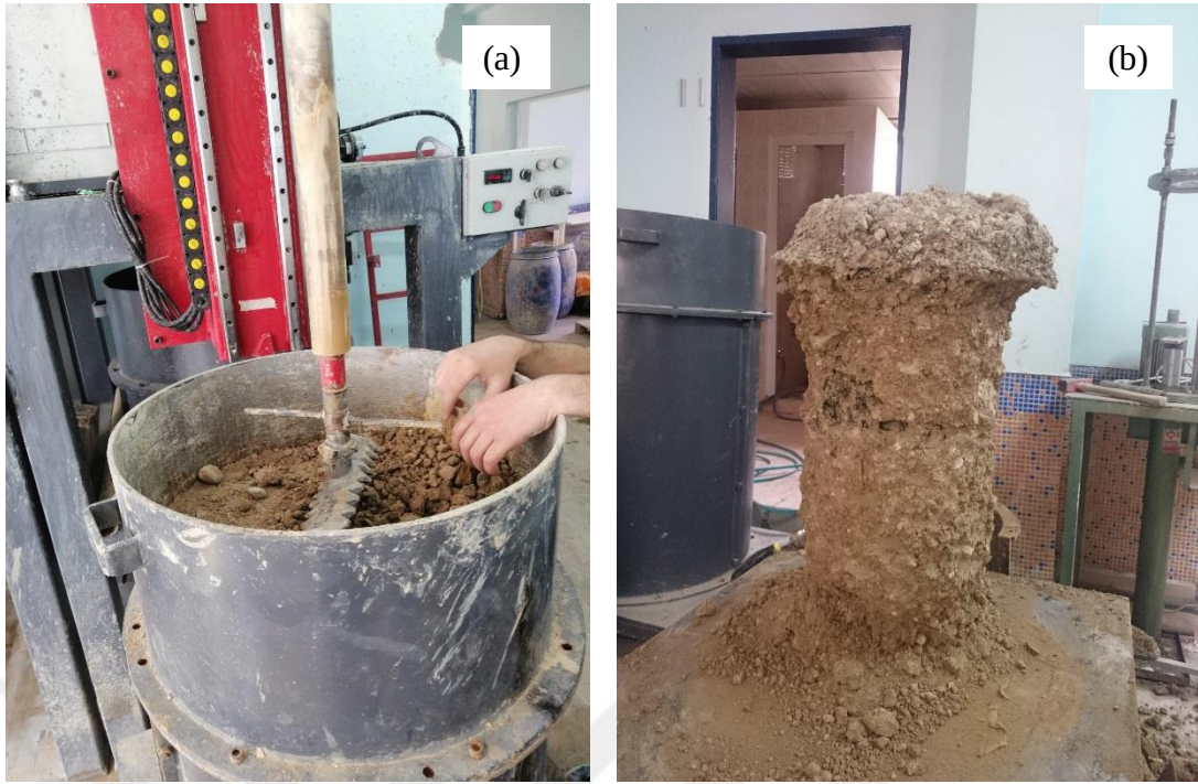
Şekil 3.29. Plastik kıvama yakın (%27) su muhtevsındaki a) zemin ortamı, b) boşluklu ve homojen karışmayan kolon
