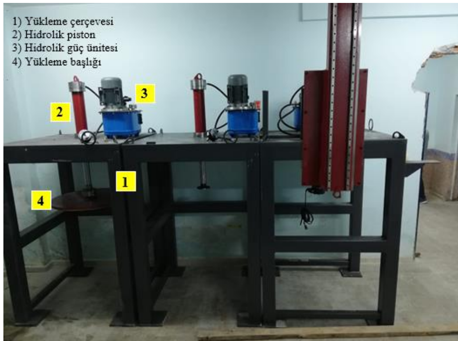
Şekil 3.21. Tasarlanan yükleme çerçeveleri ve hidrolik yükleme pistonları
