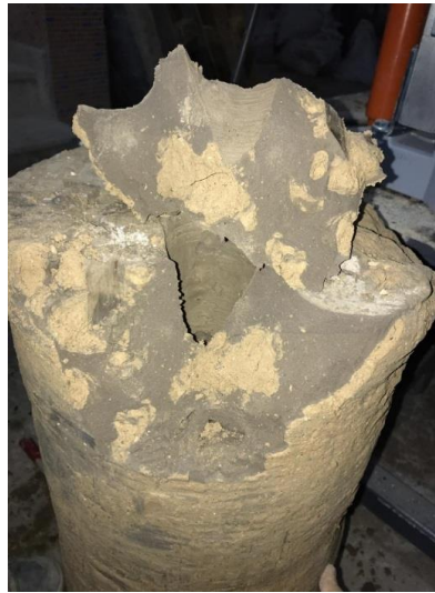
Şekil 3.28. Homojen karışmayan kolon (deneme kolonu)
