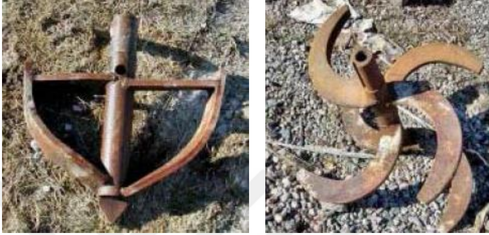
Şekil 2.7. Kuru karıştırma yönteminde kullanılan tipik karıştırma bıçakları: a) normal ve b) turba zeminler için (Topolnicki, 2004)
