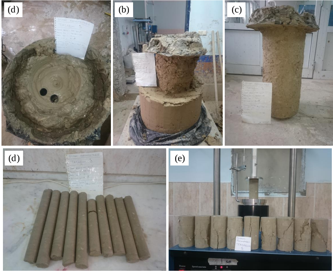
Şekil 3.43. SP-9 numaralı DKK: a) imalat sonrası görünüm, b) kolon tanktan çıkarılırken, c) imal edilen kolon, d) alınan karot numuneleri, e) UCS deneyindeki kayma yüzeyi (Sistem parametrelerinin araştırılması)
