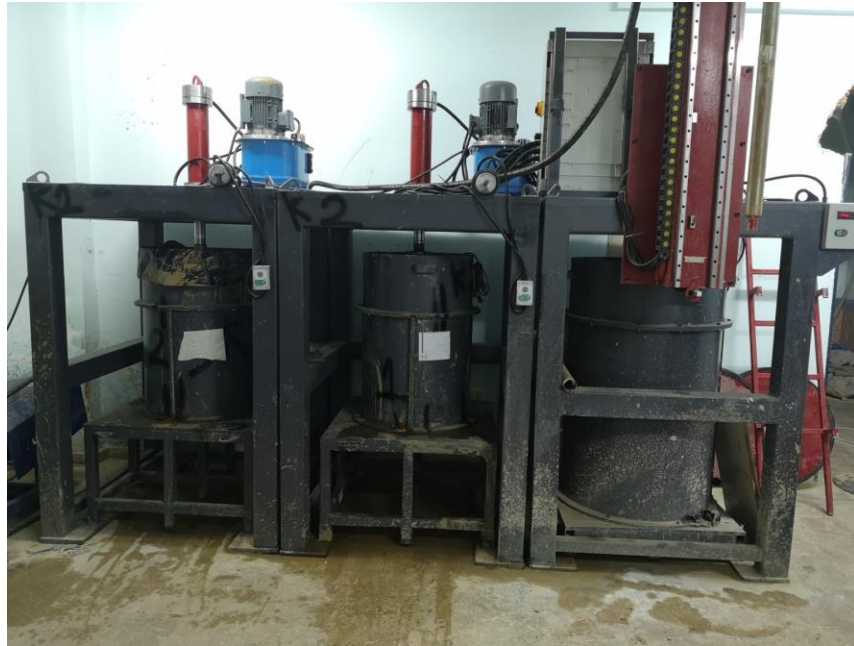
Şekil 3.33. Zeminin sabit yük uygulayan hidrolik piston altında konsolide edilmesi
