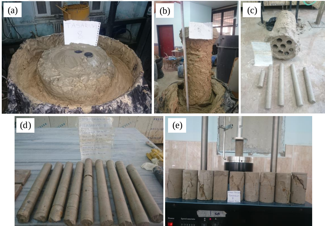
Şekil 3.42. SP-8 numaralı DKK: a) imalat sonrası görünüm, b) imal edilen kolon, c) karot alma sonrası görünüm, d) alınan karot numuneleri, e) UCS deneyindeki kayma yüzeyi (Sistem parametrelerinin araştırılması)
