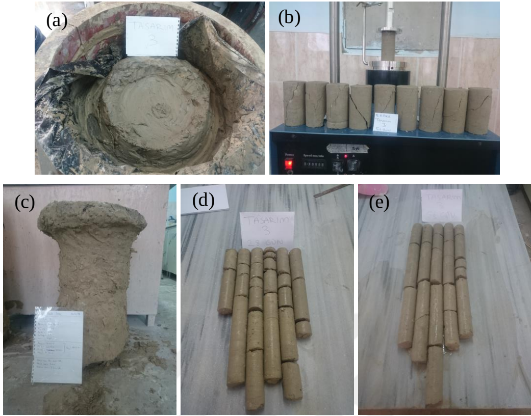
Şekil 3.54. Büyük ölçekli DKK, Tasarım 3: a) imalat sonrası görünüm, b) kayma yüzeyleri, c) imal edilen kolon, d) 28 ve e) 56 günlük karot numuneleri (büyük ölçekli DKK)
