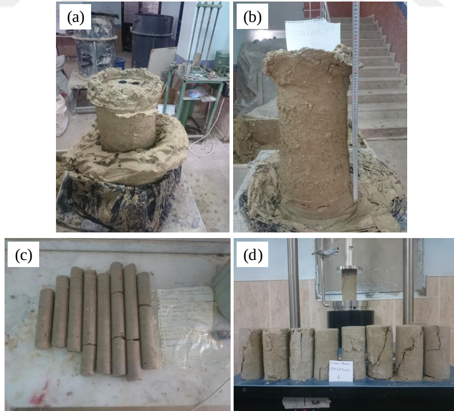
Şekil 3.40. SP-6 numaralı DKK: a) kolon tanktan çıkarılırken, b) imal edilen kolon, c) alınan karot numuneleri, d) UCS deneyindeki kayma yüzeyi (Sistem parametrelerinin araştırılması)
