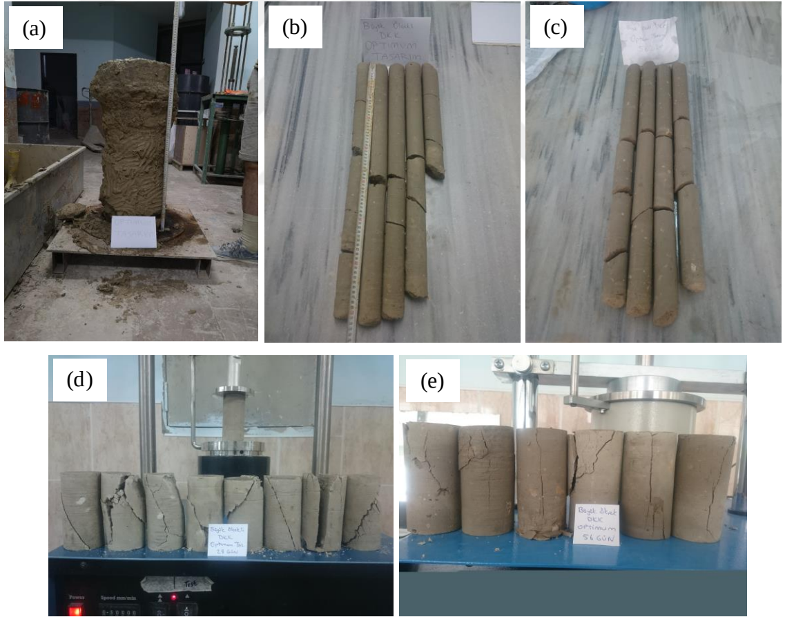
Şekil 4.80. Büyük ölçekli DKK, optimum tasarım: a) imal edilen kolon, b) 28 ve c) 56 günlük karot numuneleri, d) 28 ve e) 56 günlük kayma yüzeyleri
