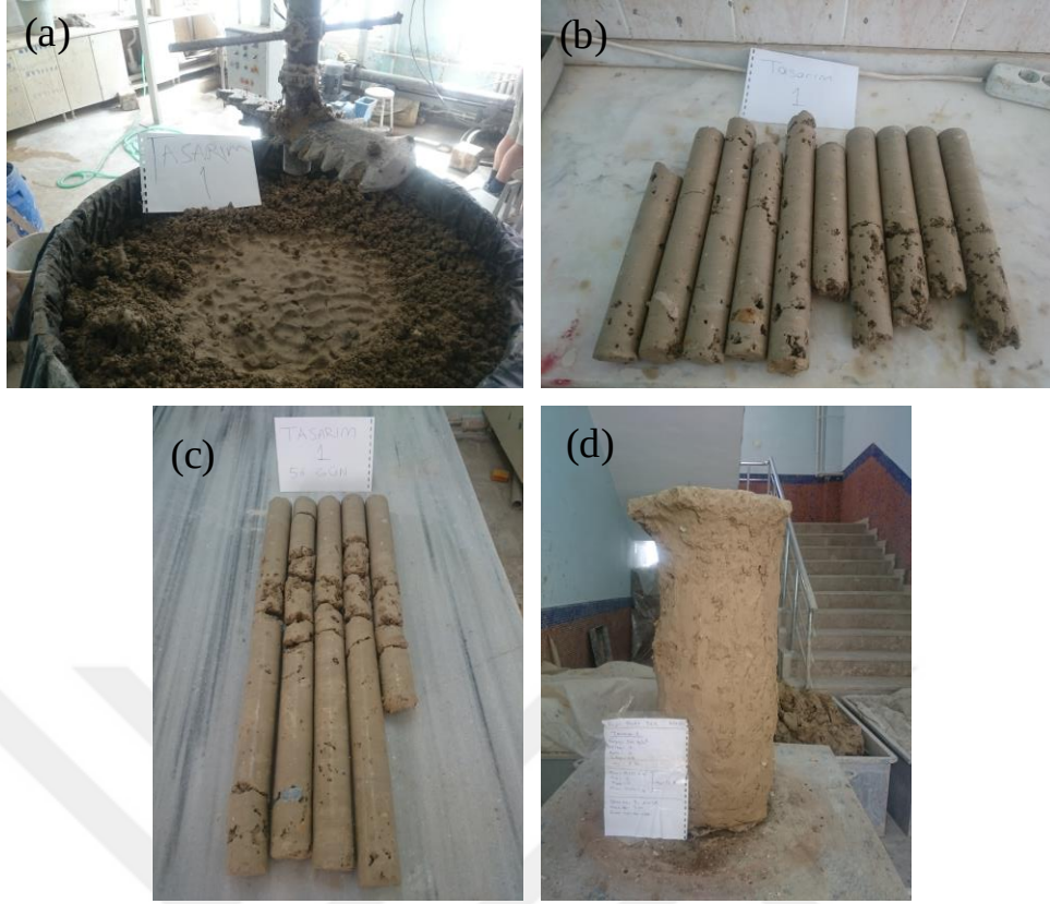
Şekil 3.52. Büyük ölçekli DKK, Tasarım 1: a) imalat sonrası görünüm, b) 28 ve c) 56 günlük karot numuneleri, d) imal edilen kolon (büyük ölçekli DKK)
