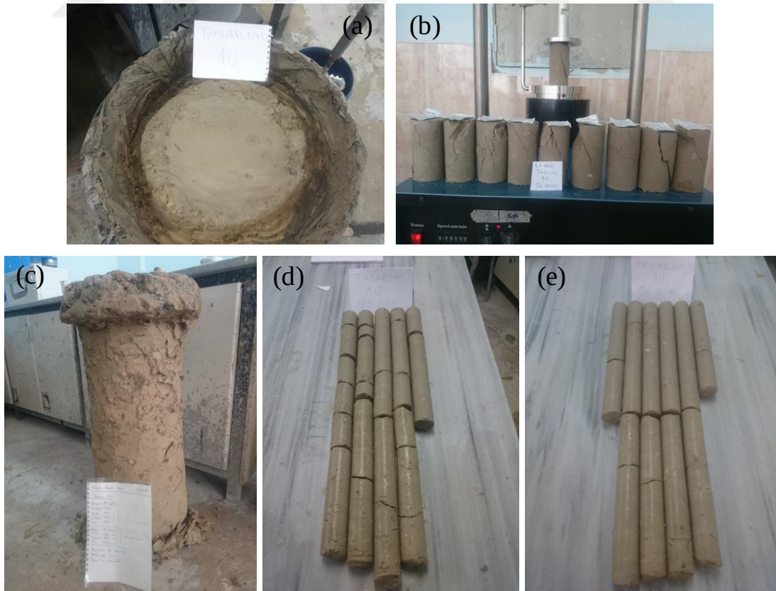
Şekil 3.61. Büyük ölçekli DKK, Tasarım 10: a) imalat sonrası görünüm, b) kayma yüzeyleri, c) imal edilen kolon, d) 28 ve e) 56 günlük karot numuneleri (büyük ölçekli DKK)
