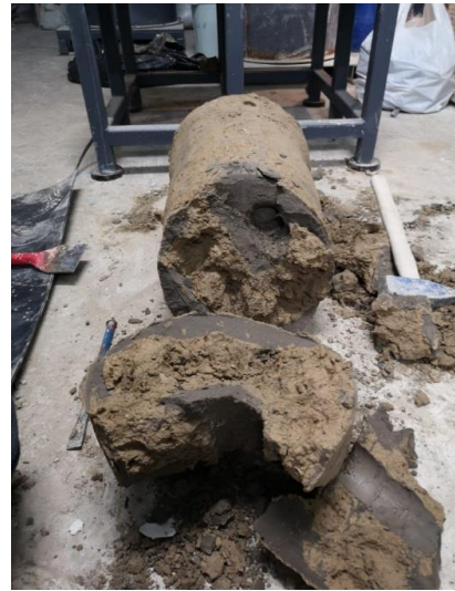
Şekil 3.28. Homojen karışmayan kolon (deneme kolonu)
