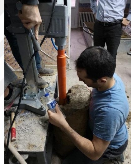
Şekil 3.27. Kolondan karot alma denemesi (deneme kolonu)
