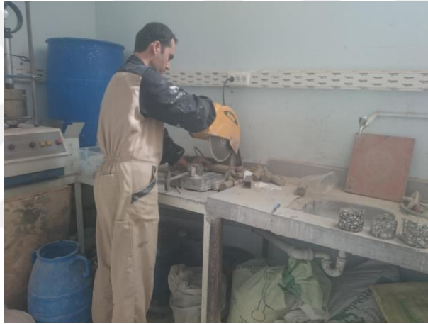
Şekil 3.24. Elektrikli testere ile karot numunelerinin kesilmesi
