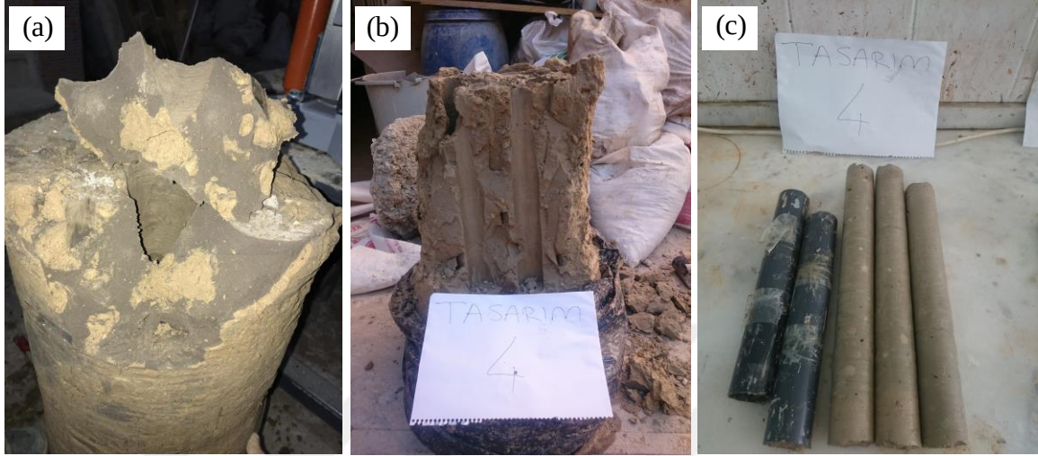
Şekil 4.14. a) Homojen olmayan zemin-bağlayıcı karışımı (DH<60 devir/dk), b, c) Homojen karışmış kolon (Tasarım 4, DH=60 devir/dk)
