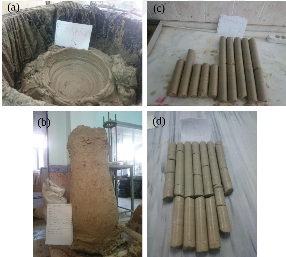
Şekil 3.57. Büyük ölçekli DKK, Tasarım 6: a) imalat sonrası görünüm, b) imal edilen kolon, c) 28 ve d) 56 günlük karot numuneleri (büyük ölçekli DKK)
