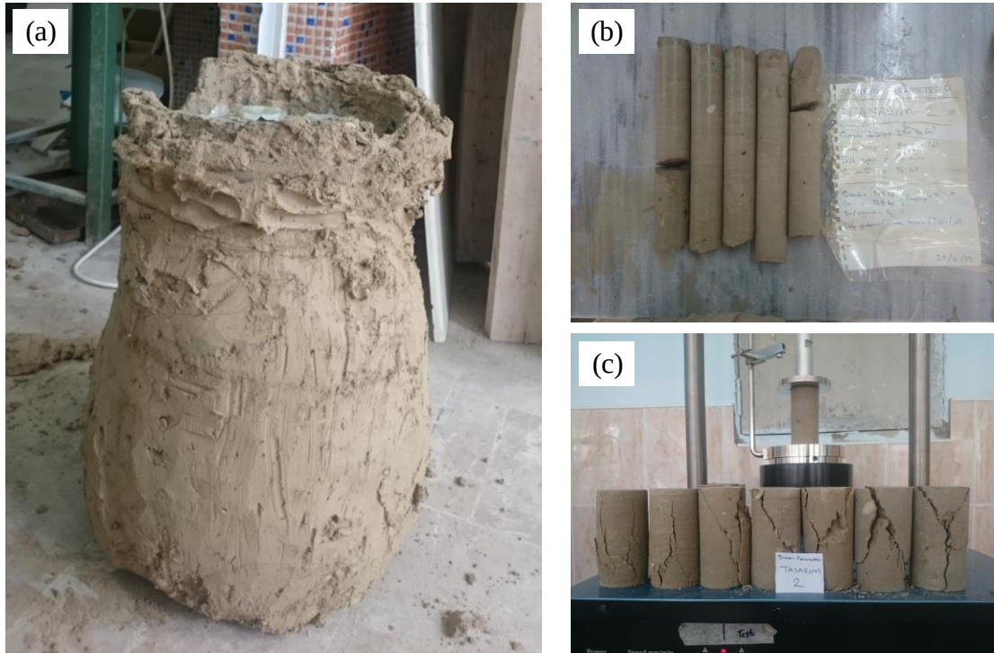
Şekil 3.36. SP-2 numaralı DKK: a) imal edilen kolon, b) alınan karot numuneleri, c) UCS deneyindeki kayma yüzeyi (Sistem parametrelerinin araştırılması)
