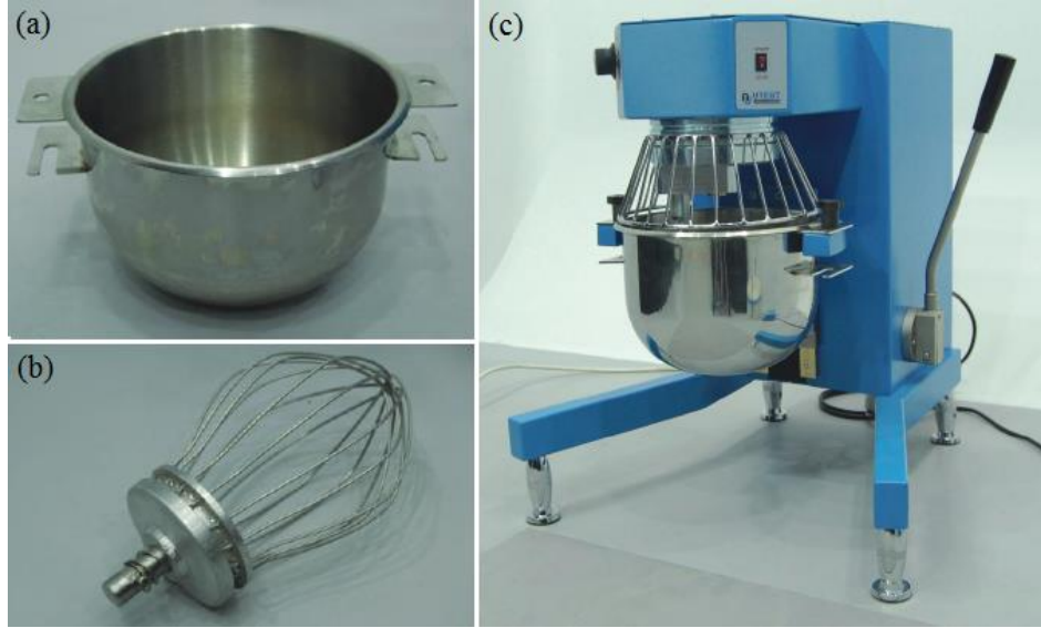
Şekil 3.25. a) Karıştırma kabı, b) çırpıcı ve c) laboratuvar mikseri
