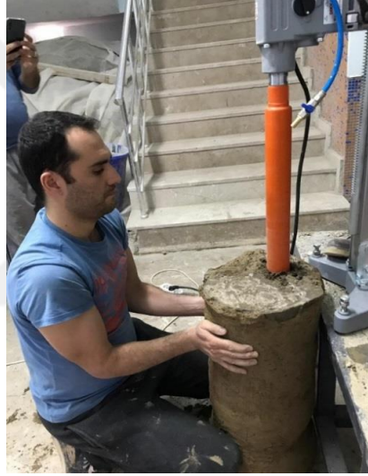
Şekil 3.27. Kolondan karot alma denemesi (deneme kolonu)
