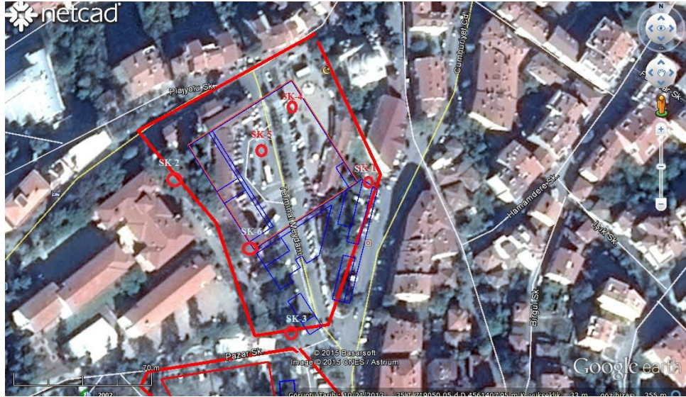
Şekil 4.3. Sondaj yerleşim planı.
