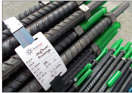
Şekil 2.7. Zemin çivileri (pasif ankraj).
