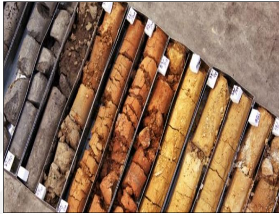
Şekil 2.23. Tipik sondaj logları.
