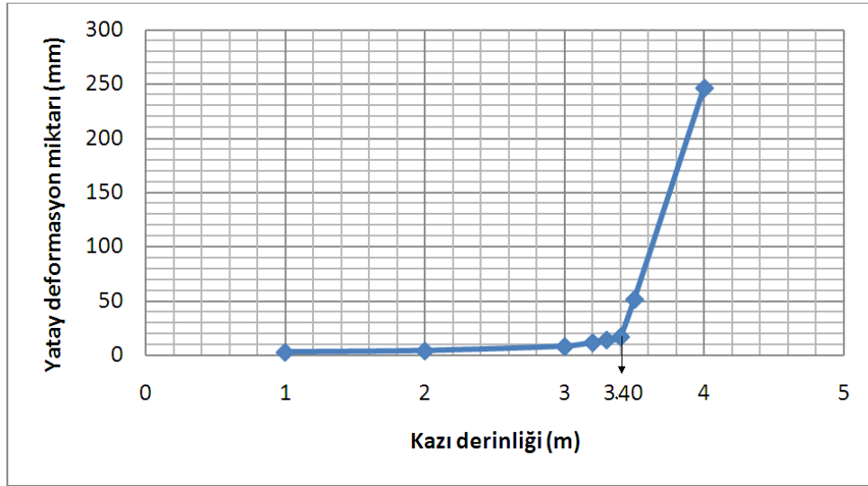
Şekil 4.8. Desteksiz kazı derinliği (m) – yanal deformasyon miktarı (mm) eğrisi
