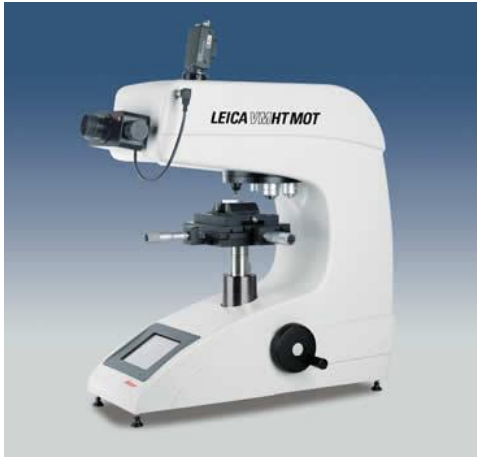
Resim 4.12. Mikro sertlik ölçümü yapılan Leica marka cihaz
