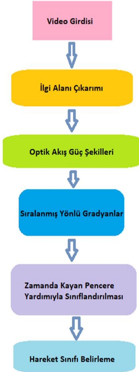
Şekil 3.9 Tahminleme sisteminin yapısı
