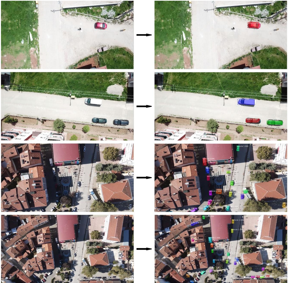
Şekil 5.4. Mask R-CNN ile Bilecik/Pazaryeri Görüntülerinden Araç Tespiti Örnekleri
