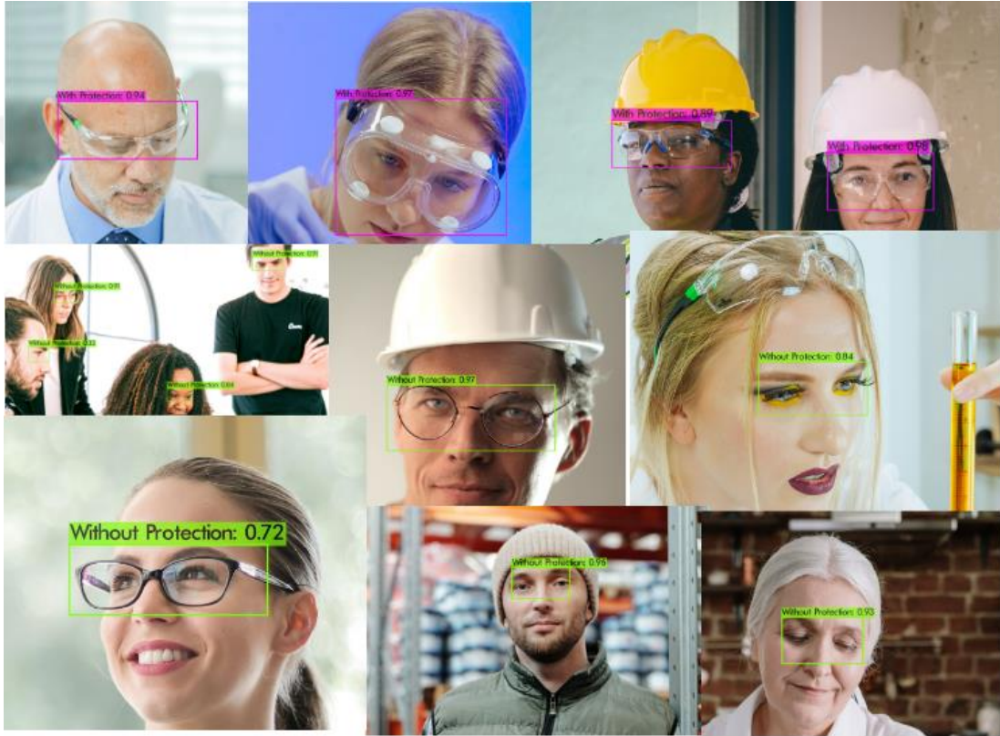
Şekil 3.40. Göz koruma kontrol modelinin test sonuçları
