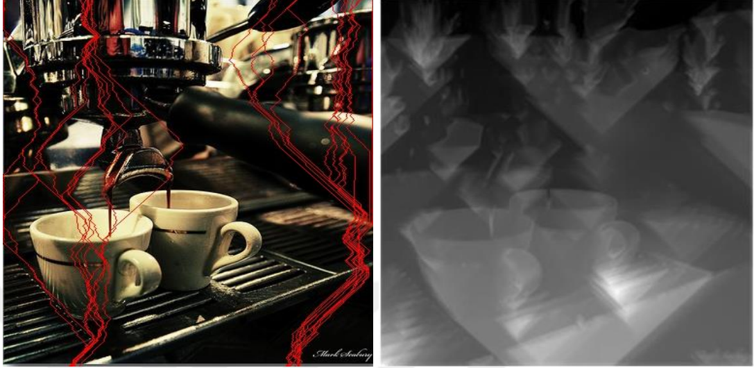
Şekil 2.1. Orjinal görüntü (dikey optimal seam yolu) ve enerji haritası
