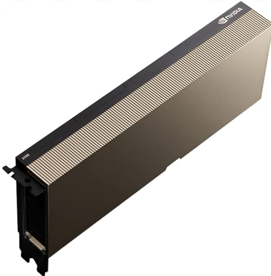
Şekil 22. Çalışmada kullanılan sanal Nvidia A100 (40G) ekran kartı
