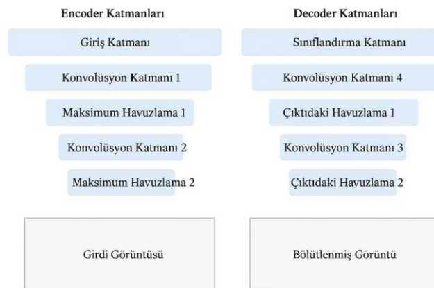
Şekil 2.2. SegNet mimarisi diagramı
