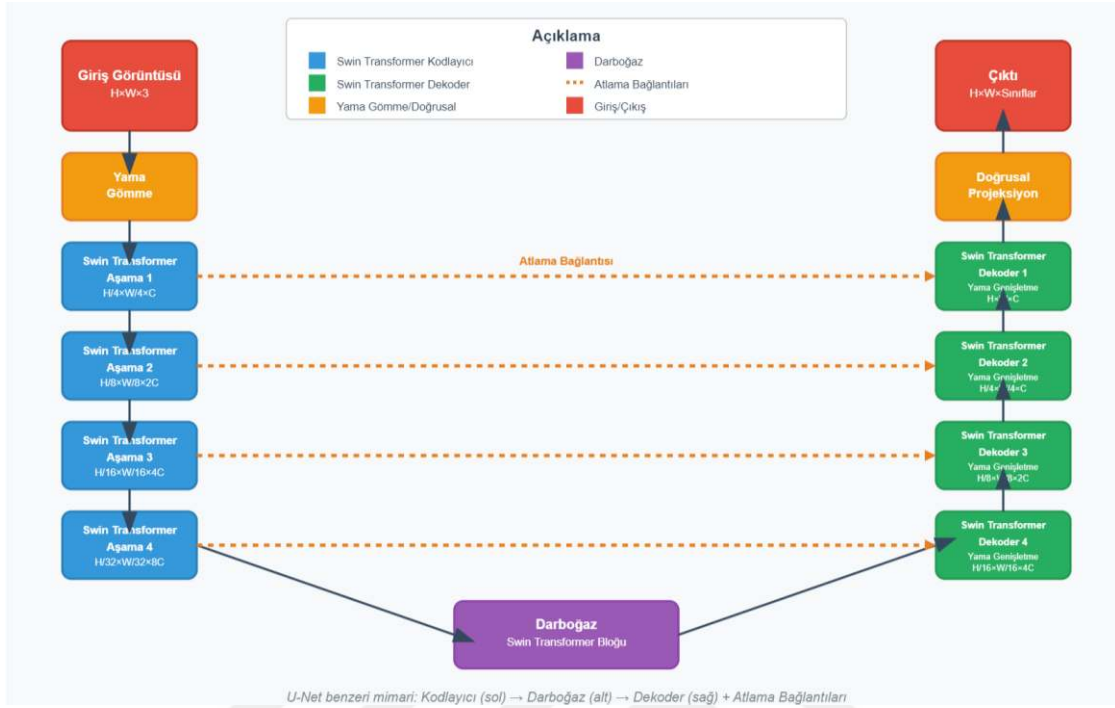
Şekil 2.8. Swin-Unet algoritması blok diagramı
