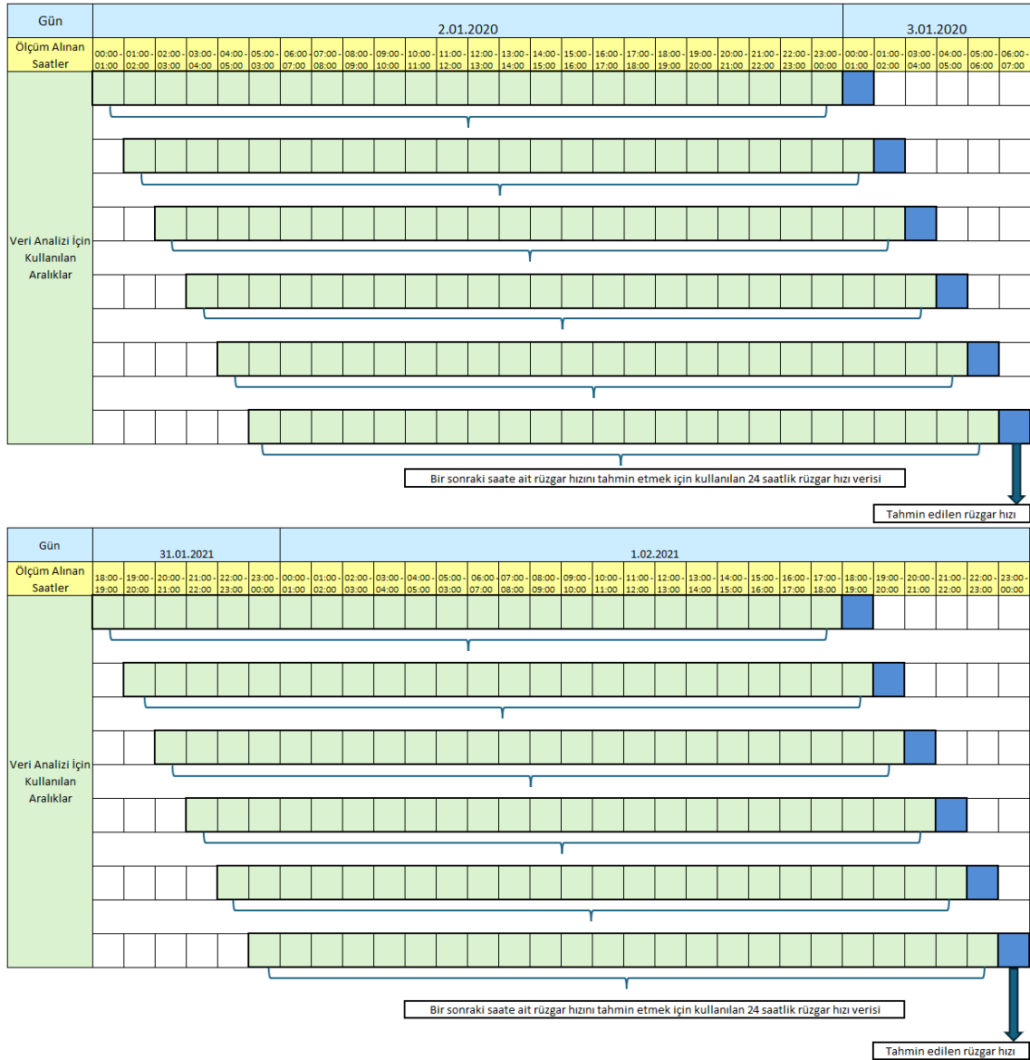
Şekil 5.4. Bir saat ilerisi için tahmin üretme yöntemi
