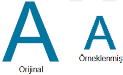
Şekil 4.8. Ortaklama işlemi yapılmış girdi ve düşük çözünürlüklü çıktı
