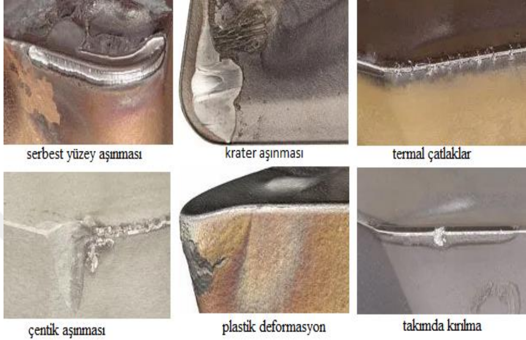
Şekil 1. 3. Kesici takımda aşınma tipleri
