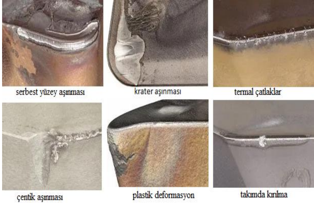
Şekil 1. 3. Kesici takımda aşınma tipleri
