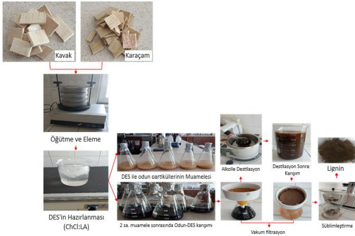
Şekil 3.1: Lignin üretiminin kısa özeti.
