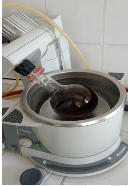
Şekil 2.8: Elde edilen siyah DÖÇ'lerin döner damıtma işlemi.
