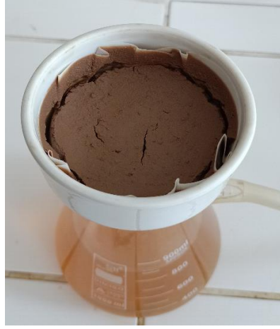
Şekil 2.10: Ligninörneklerinin vakum filtrasyon işlemi.
