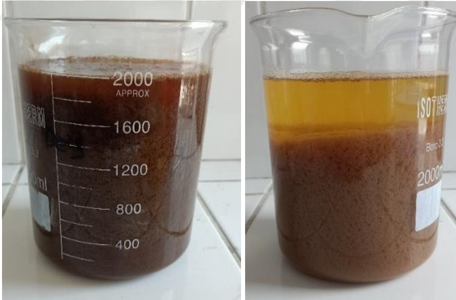
Şekil 2.9: Çözeltiye Saf Su İlavesi İle Lignin Çöktürülmesi.
