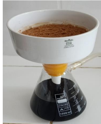
Şekil 2.7: Siyah DÖÇ çözeltilerinin vakum filtrasyon işlemi.
