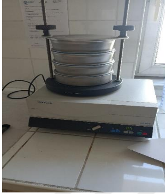
Şekil 2.3: Tüm odun yongalarının elekte sınıflandırılması.
