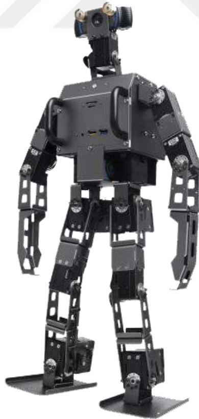
řekil 2.9 Robotis firması tarafından üretilen Robotis-OP3
