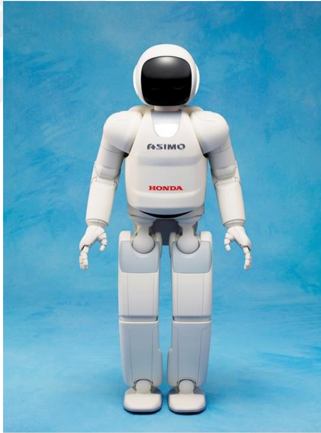
řekil 1.4 Honda tarafından geliřtirilen insansı robot Asimo [52]
