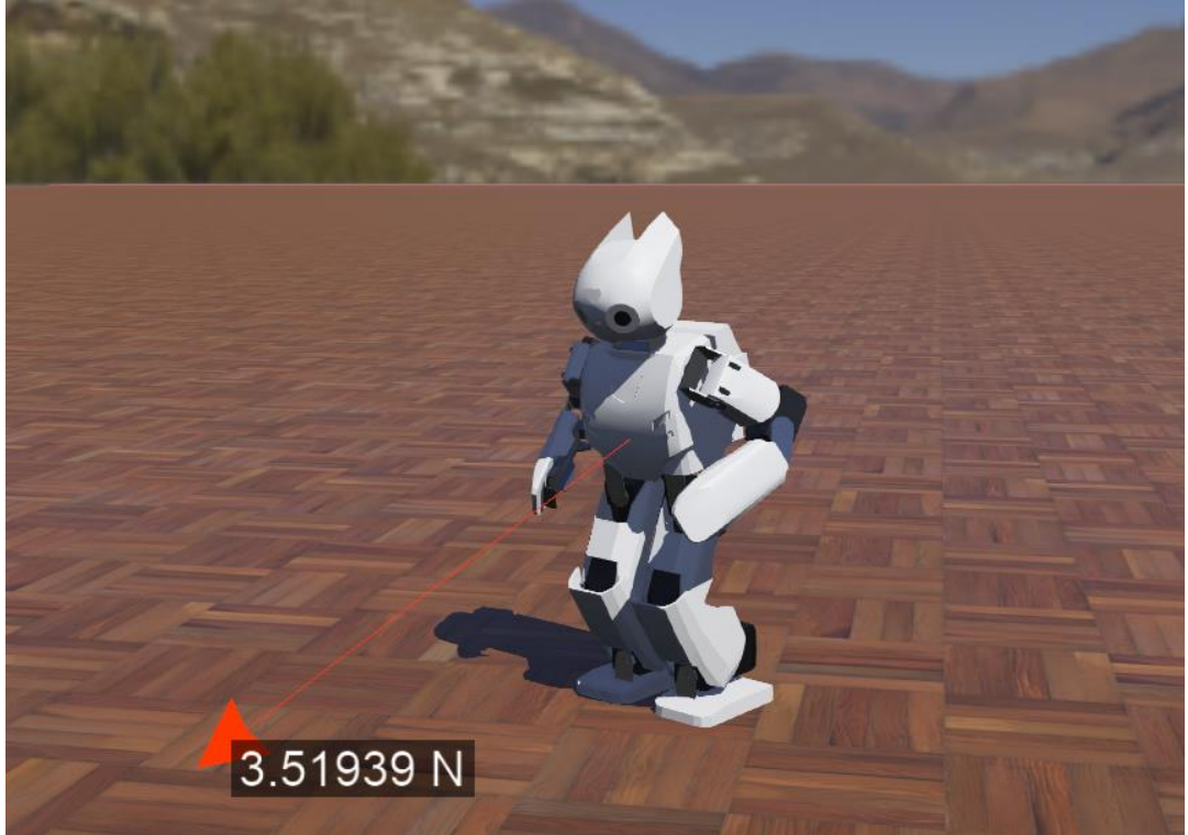
Şekil 6.15 Robota manuel olarak itme kuvveti uygulanması
