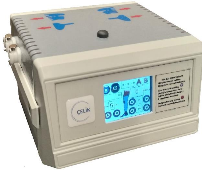
Şekil 2.17 Değişken DVT pompa tasarımı
