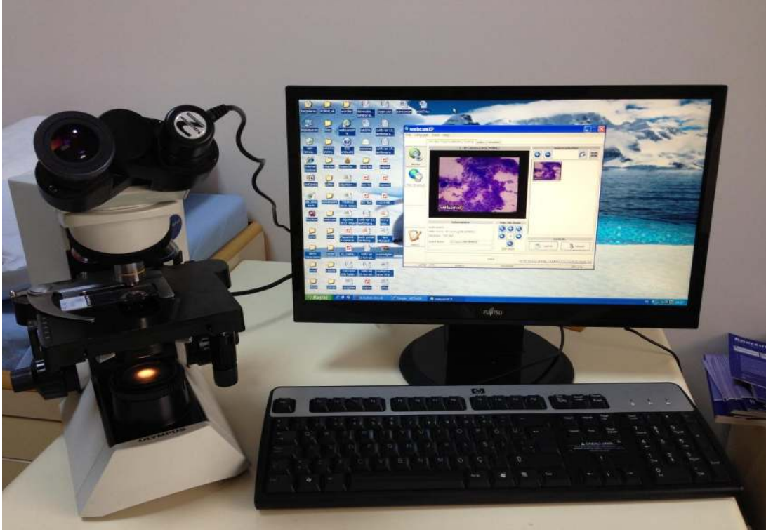
Şekil 3.4 Eşzamanlı dinamik dijital mikroskopi yöntemi ile bilgisayara görüntü aktarımı.
