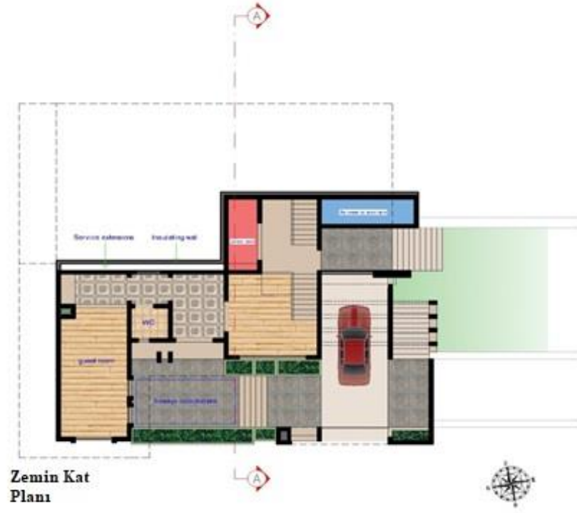
Şekil 4.10 Önerilen yerleşim birimi için zemin kat planı
