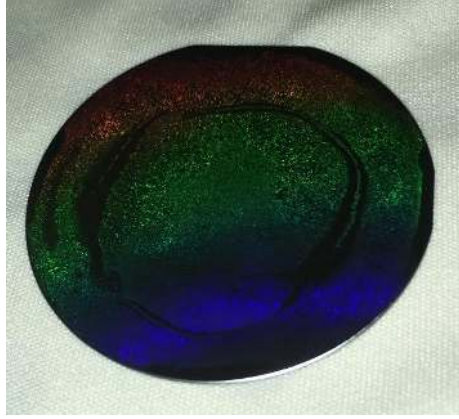
Görsel 4.14. MACE sonrası düzenli desenlenmiş büyütme işlemi için hazır 2 inç Si alttaşı görüntüsü
