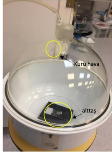
Görsel 4.7. Kuru hava yardımıyla desikatör içerisinde kendiliğinden solvent buharlaştırma yöntemi deney düzeneği
