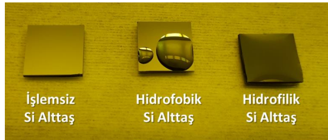
Görsel 4.1. İşlemsiz ve çeşitli işlemler ile “hidrofobik” ve “hidrofilik” hale getirilmiş 10×10 mm 2 kesilmiş Si altaşlar
