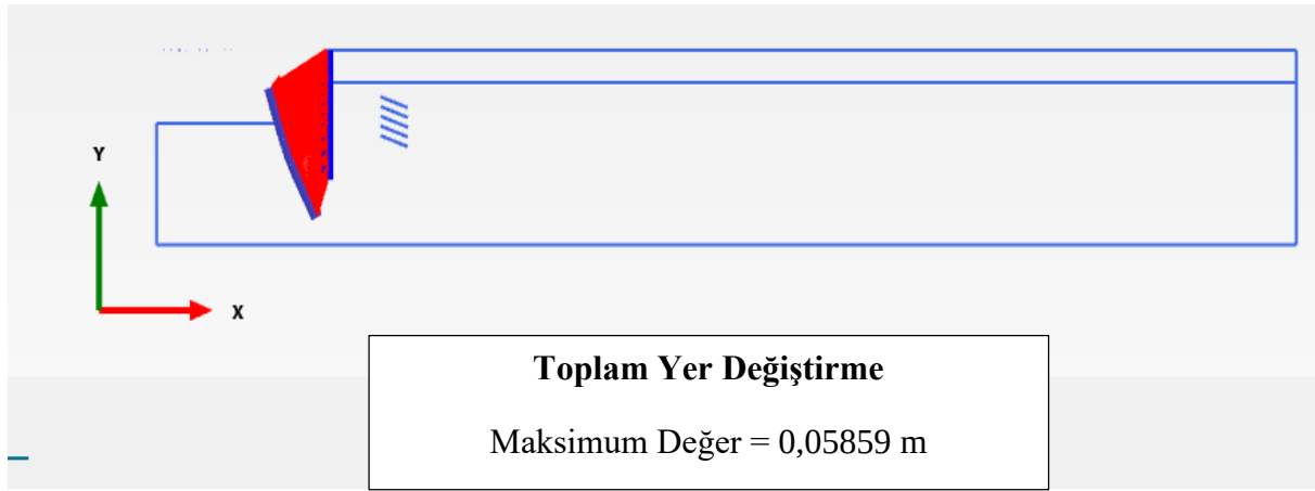
Şekil 6.17 Ankrajlı yapılan kazığın oluşturduğu deformasyon.
