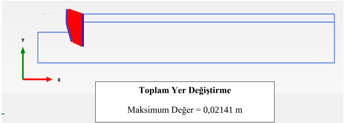
Şekil 6.19 Ankrajsız yapılan kazığın oluşturduğu deformasyon.
