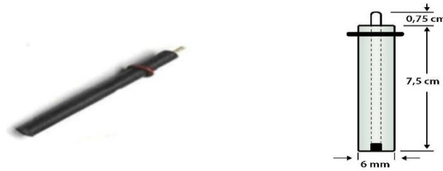
Şekil 1.13. Camsı karbon çalışma elektrodu yapı gösterimi.
