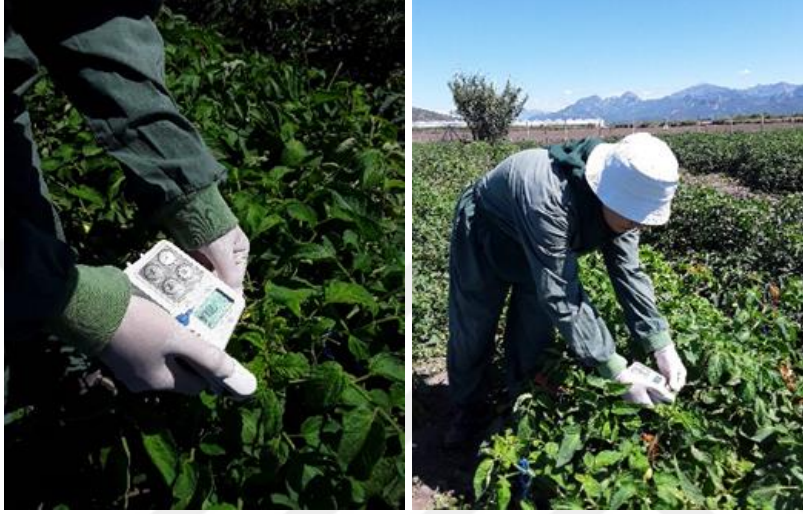
Şekil 3.8. Domates yapraklarında klorofil ölçümünden görüntü
