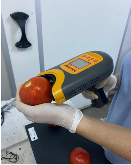
Şekil 3.7. Sunforest H-100C Brix ölçer cihazı
